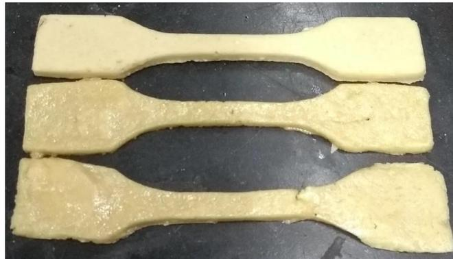
**Figura 19.** Evolución de consistencia de probetas de poliuretano.
