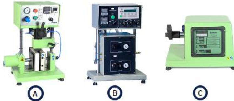
**Figura 24.** Equipos utilizados para realizar el proceso Cold Box.
