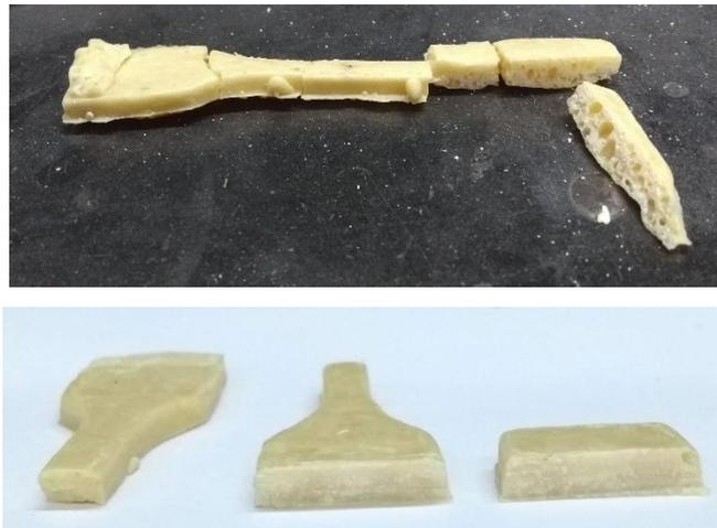
**Figura 18.** Probeta porosa (superior) y probeta que presenta una porosidad mínima, ideal para pruebas de resistencia mecánica (inferior)
