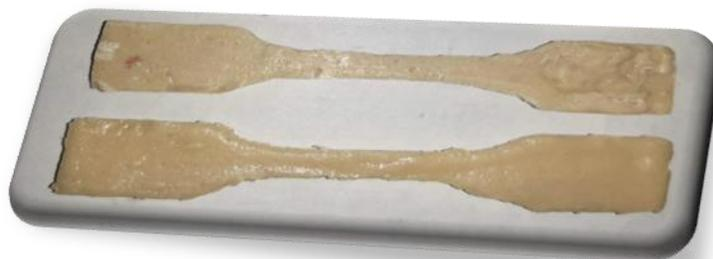
**Figura 26.** Ejemplo de las probetas fabricadas dentro del molde de silicon
