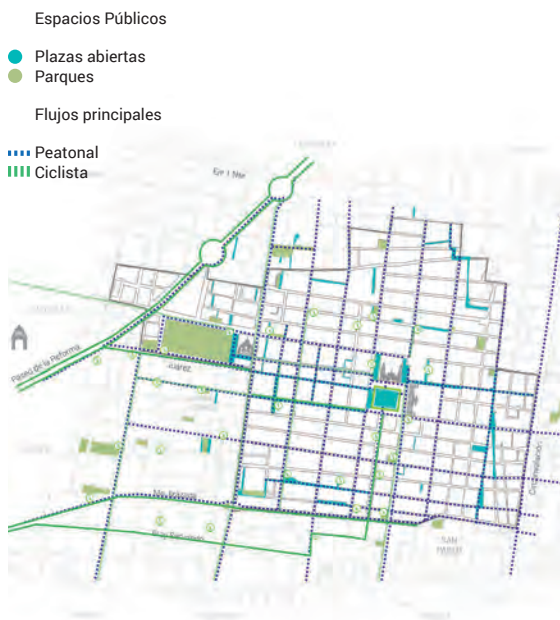
Mapa de la relación de la movilidad ciclista, los principales flujos peatonales y espacios abiertos. Imagen Propia.
