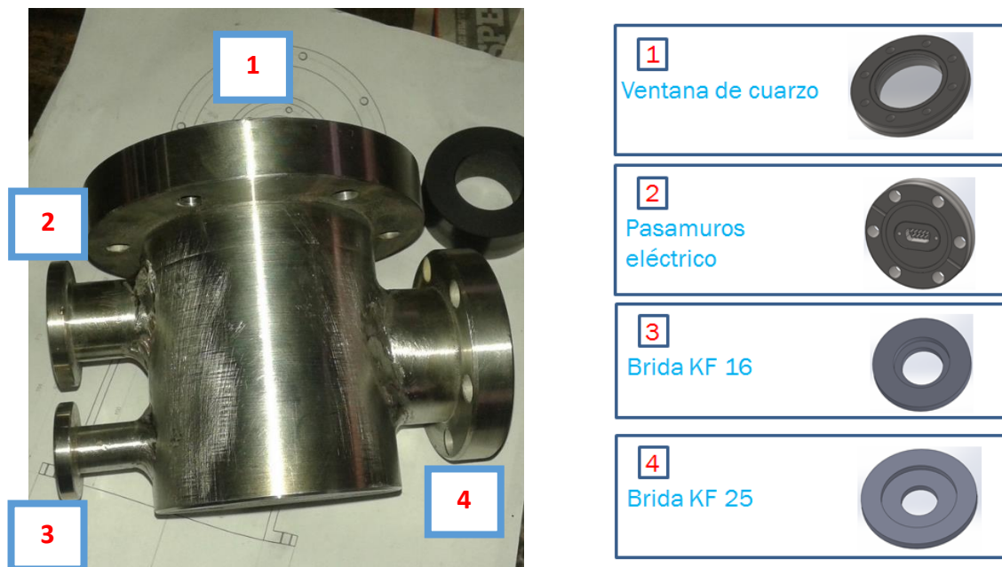
Figura 4.26. Cámara de vacío para el porta muestras. Izquierda: cámara de vacío. Derecha: componentes de la cámara.
