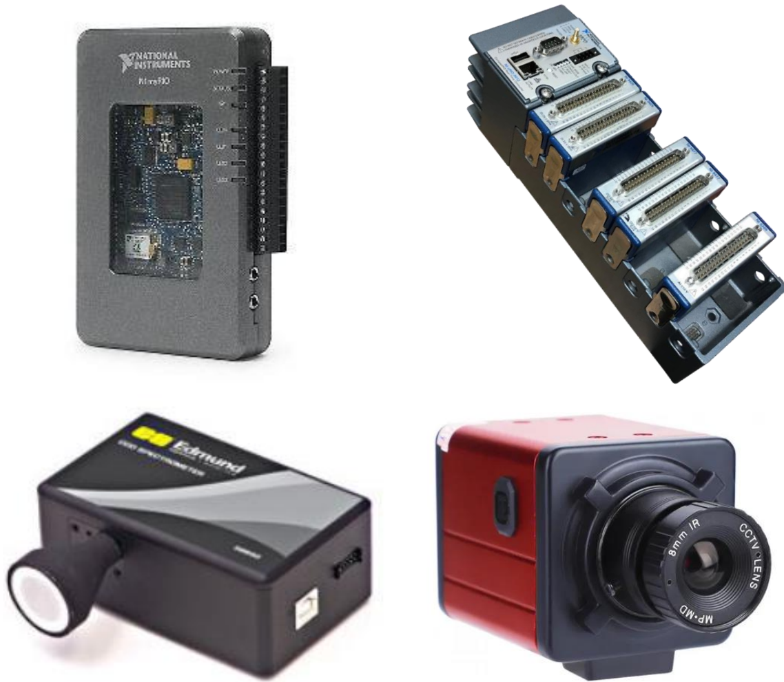
Figura 4.34. Superior; sistemas de Adquisición datos. Izquierda: controlador NI MyRIO. Derecha: controlador CompactRIO. Inferior; sistema de toma de imágenes. Izquierda: espectroradiómetro compacto 58657 de Edmund Optics. Derecha: cámara CCD
