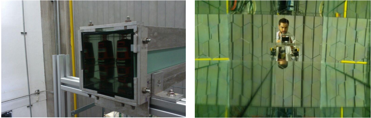
Figura 3.7. Primer experimento de homogeneización de flujo radiativo. Izquierda; Primer homogeneizador de flujo radiativo con paredes internas de espejos de segunda superficie; Derecha: fotografía de las paredes internas del homogeneizador.
