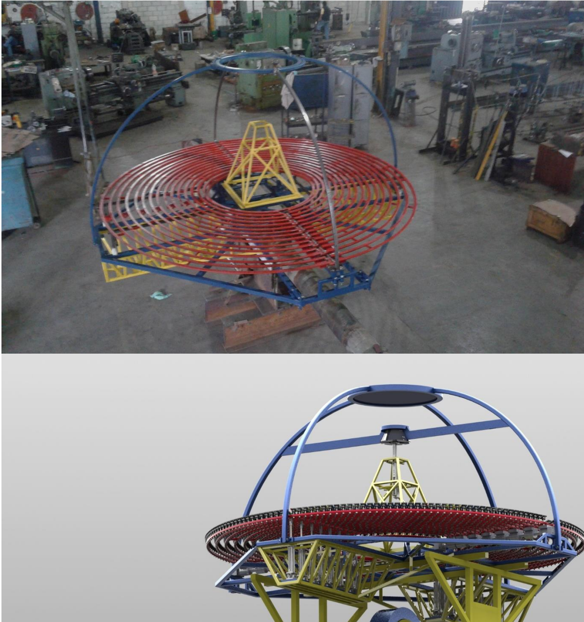
Figura 4.24. Soporte de espejo secundario, en la parte superior, vista lateral del soporte para el espejo secundario; en la parte inferior vista isométrica.
