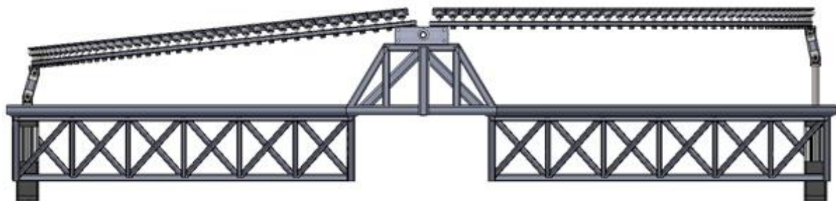
Figura 4.21 Arreglos Semicirculares del Primer Elemento Óptico sobre el ESPEO con dos actuadores lineales.
