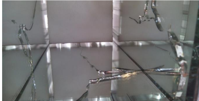
Figura 3.9. Homogeneizador de flujo radiativo fracturado por estrés térmico.
