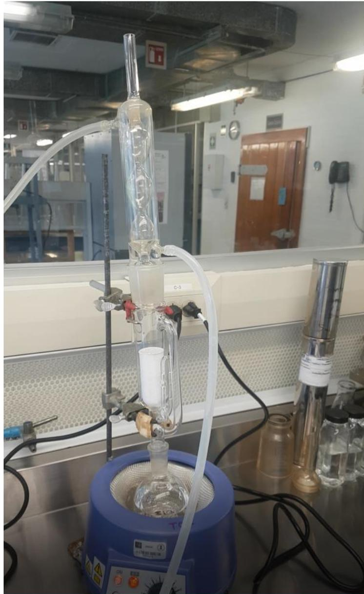
***Ilustración 8. Montaje de equipo de extracción soxhlet***
