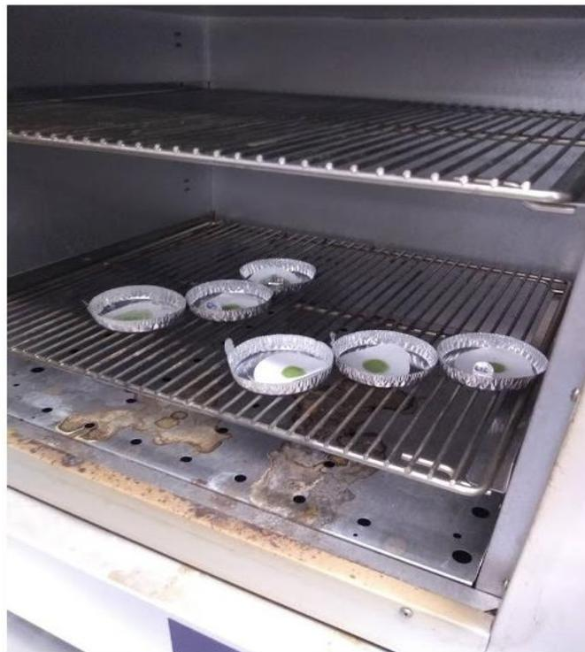
**Ilustración 9. Filtros en horno de secado**
