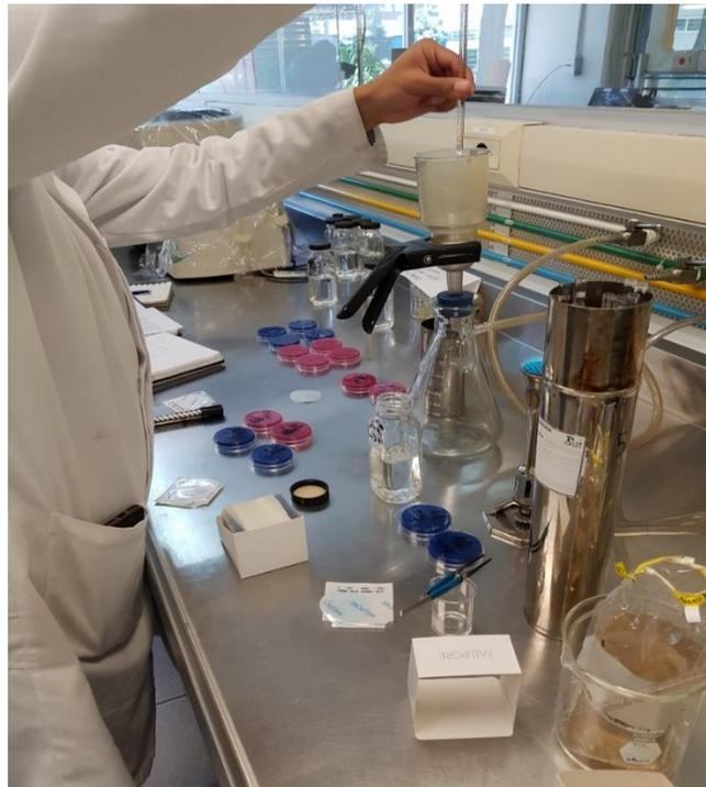
***Ilustración 11. Proceso de filtración de coliformes***
