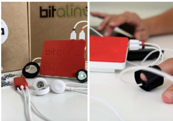
Sensor Bitalino ECG Imagende dominio público tomada de Web Bitalino Bitalino.com /Products/heartbit-bt
