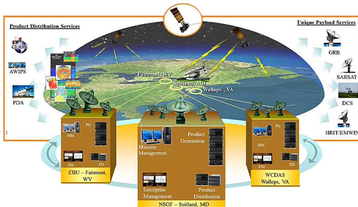
Figura 3.5: Segmento terrestre y sistema general de GOES-R. Obtenido de The GOES R Series , 2019.
