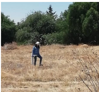
Fig. 45. Adquisición de datos magnéticos con el método de gradiente magnético.
