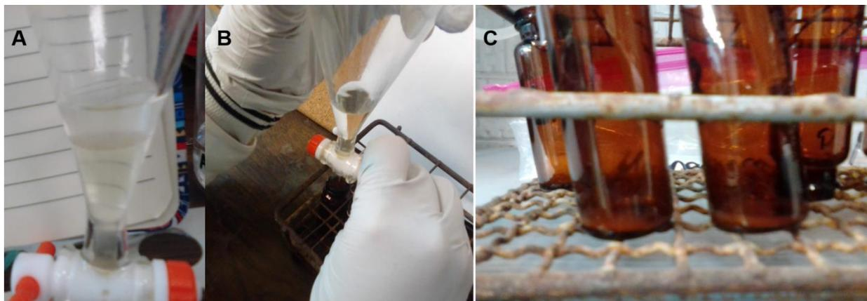
**Figura 14.** Separación de los lípidos totales (en cloroformo) de la fase acuosa. A, formación de las dos fases; B, separación de la fase densa en el vial; C, evaporación del cloroformo.
