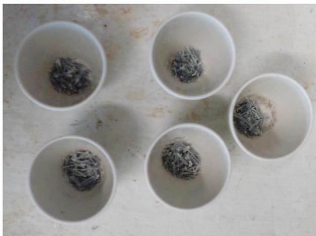
**Figura 10.** Cenizas de semillas de *Dahlia* después de ser incineradas por 6 h en una mufla Thermo Scientific™ FB1310M, ajustada a 600 °C.
