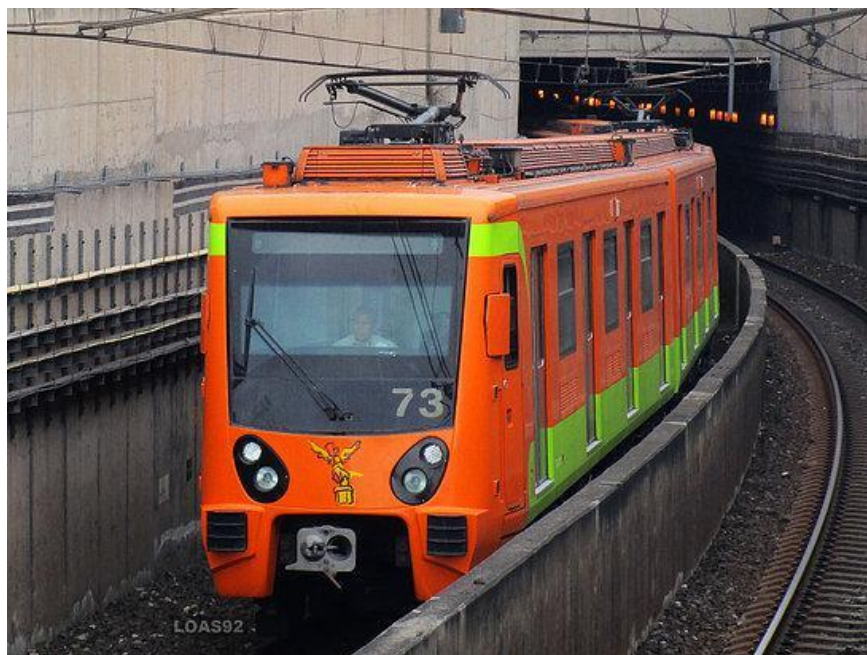
Ilustración 25. Tren energizado con catenaria, línea A del metro de la Ciudad de México. https://fotolog.miarroba.com/metroferreo/caf-fe-07-metro-ferreo-188/
