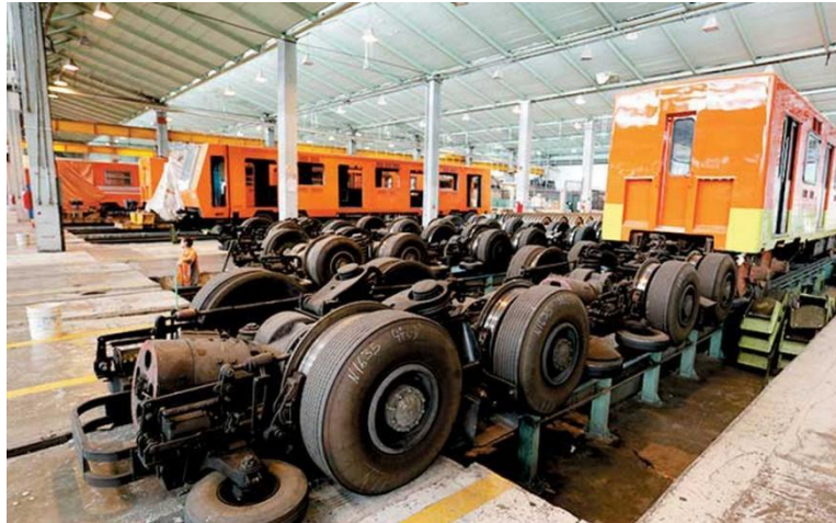
Ilustración 26. Bogies del STC Metro de la CDMX. Fotografía tomada del portal de noticieros Milenio.
