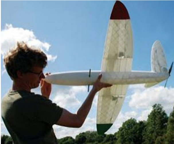
Figura 7. El primer avión impreso en 3D realizó su primer vuelo con éxito en Witshire Downs, al norte de Stonehenge. Los ingenieros Ady Keane y Jim Scanlan pronosticaron que esta tecnología ahorraría tiempo y dinero en la creación de vehículos aéreos no tripulados (UVA). 26
