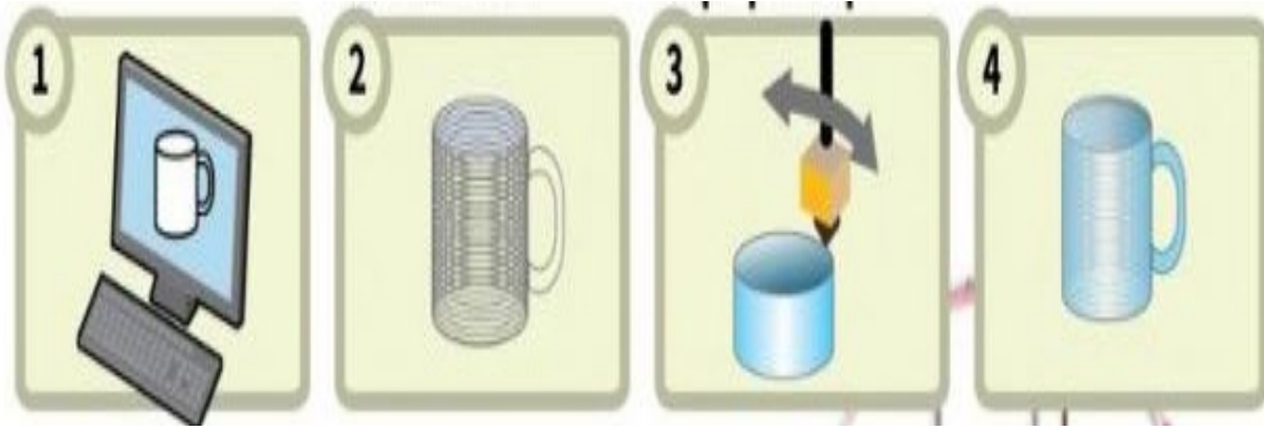
Figura 22. Proceso de modelado e impresión 3D. 1) Diseño, creación o descarga del modelo 3D. 2) Conversión del modelo 3D al formato STL para su preparación, reparación y laminado. 3) Impresión del modelo 3D por una máquina de prototipado rápido. 4) Obtención del modelo 3D previo a la fase de limpieza, pulido y acabado. 47
