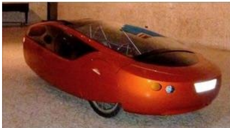
Figura 8. Conoce a Urbee, el auto que nació de una impresora 3D. Toda su carrocería fue creada usando una impresora con material ABS, debajo de su caparazón, el chasis está hecho de acero inoxidable. 27
