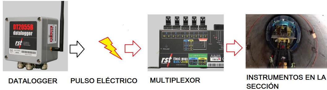
Figura 82 Principio básico de funcionamiento de un sistema de monitoreo automatizado
