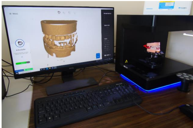
Fig. 33 Posición y digitalización del modelo en el escáner mecánico
