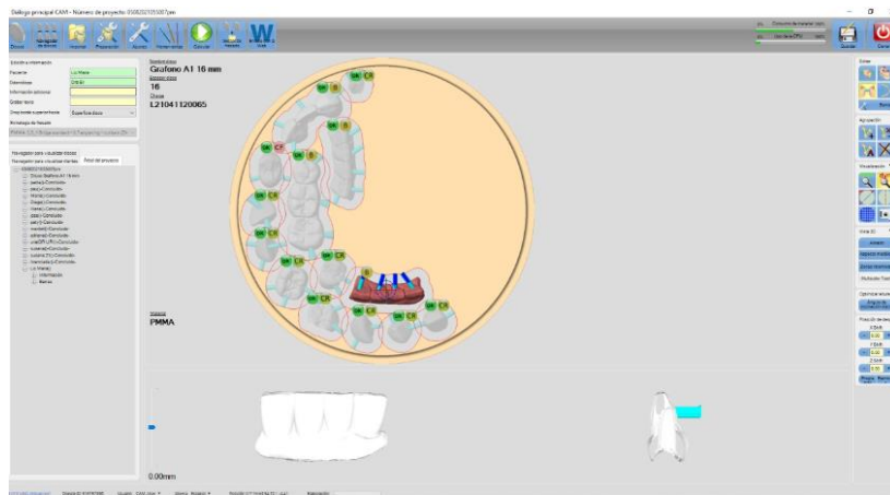
Fig. 45 Posicionamiento del diseño en el disco del material a fresar
