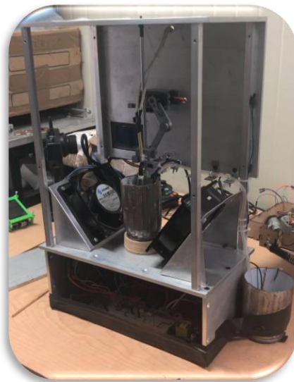
Figura 15. Fotografía del sistema robotizado destinado a demostrar la ley de enfriamiento de Newton elaborado por los participantes Roberto Ángel García García y Zaa Ribe Jazmín Ramírez Grajeda. Tomada por I. Cruz, 2019.
