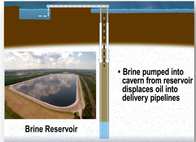
Figura 6. Bombeo de la salmuera al interior de la Caverna vertical para el desplazamiento del aceite aun oleoducto. (Fuente Recuperado de: https://www.youtube.com/watch?v=YL6eA_L8lm8&t=166s ).
