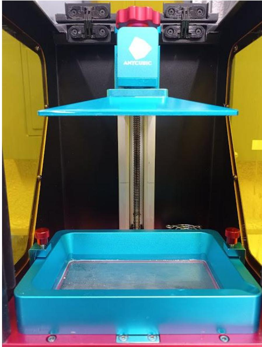
Figura 25 Componentes de impresora 3D “*Anycubic Photon*”® Fotografía tomada en el Laboratorio Digital de Prótesis Bucal e Implantología de DEPeI, Facultad de Odontología UNAM
