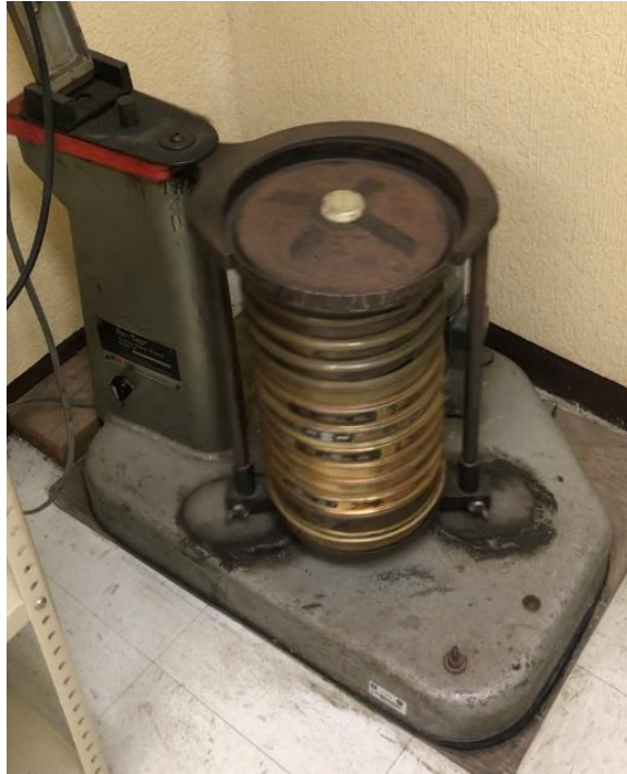
Fig. 7.2.1.1. Tamizador Ro-Tap agitando la columna de tamices para la separación de sedimentos por tamaño de grano (Laboratorio de Sedimentología, Instituto de Ciencias del Mar y Limnología UNAM).
