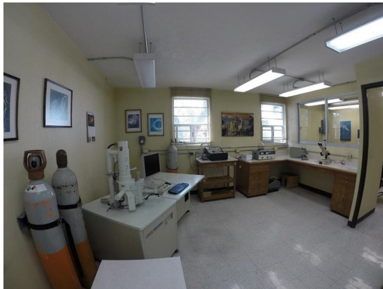
Fig. 7.2.3.1. Microscopio Electrónico de Barrido utilizado para la toma de micrografías de microplásticos, ubicado en el Instituto de Ciencias del Mar y Limnología, Ciudad Universitaria.
