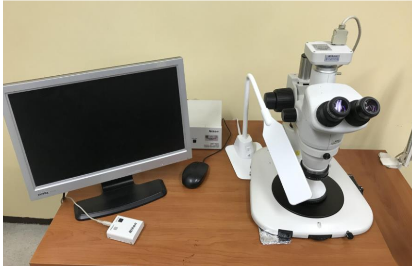
Fig. 7.2.2.1 Microscopio estereoscópico utilizado para el análisis de microplásticos (Laboratorio de Sedimentología, Instituto de Ciencias del Mar y Limnología UNAM).
