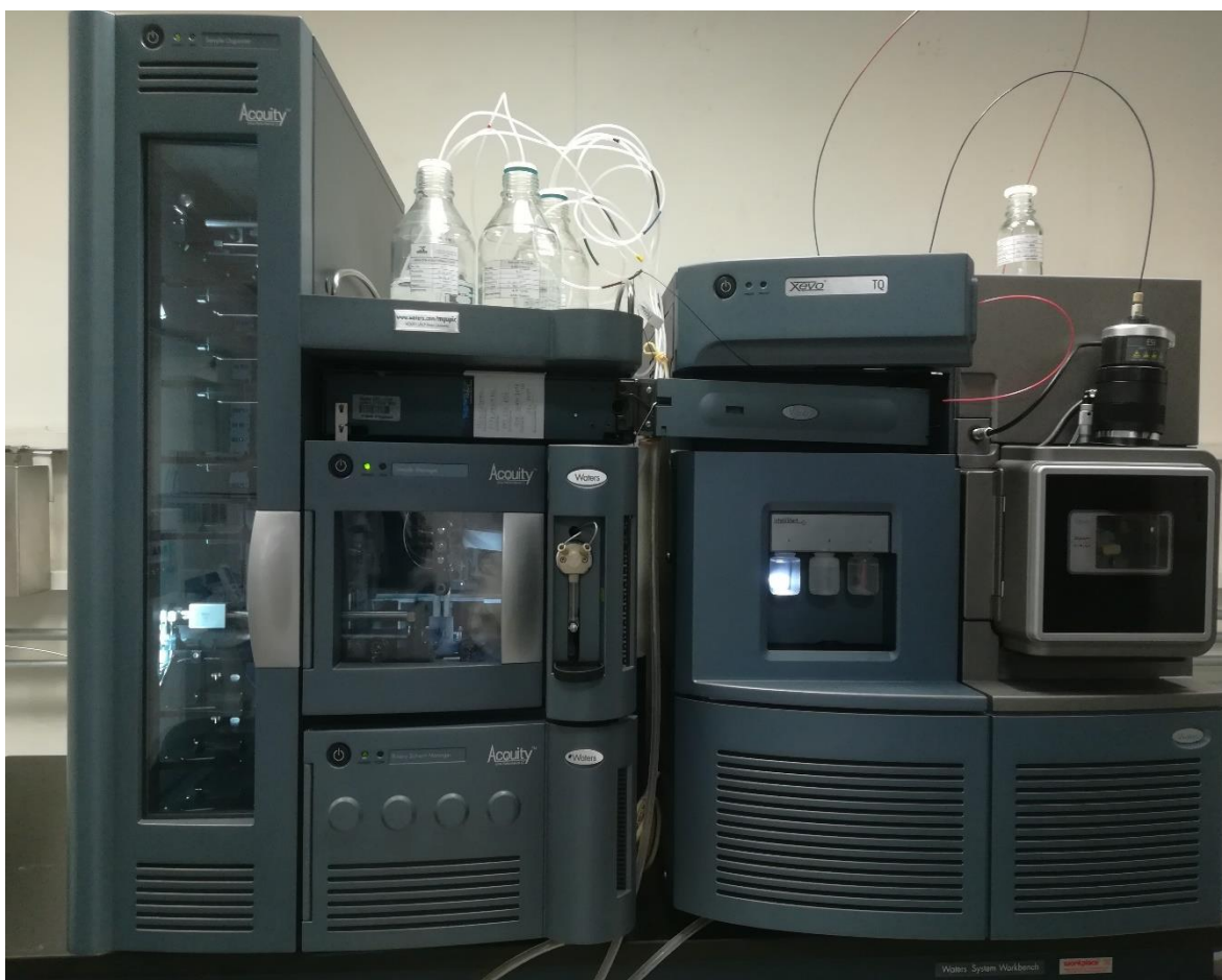
Figura 12. Cromatógrafo de líquidos Acquity™ Ultra Performance LC acoplado a un espectrómetro de masas Xevo™ TQ marca Waters.
