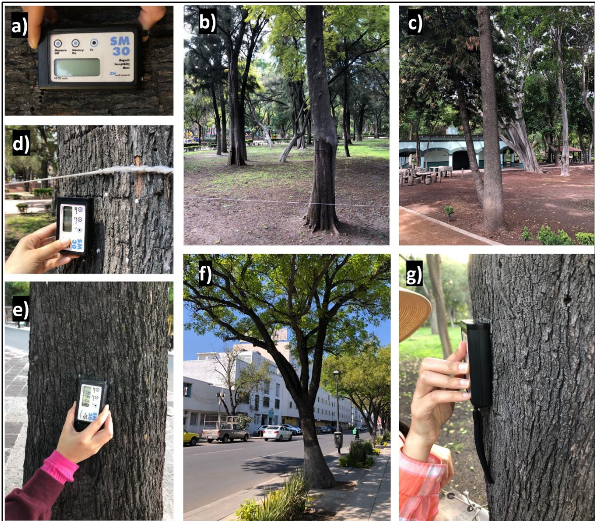
Figura 6: Fotos representativas de la metodología seguida: a) SM-30; b) tronco de árbol mojado por aspersores de riego; c) tronco recto; d) corteza de árbol erosionada por factor antropogénico; e) toma de medición de k_{is} sobre la corteza; f) banqueta de Av. Corregidora al lado del parque Alameda y flujo vehicular; g) SM-30 colocado directamente sobre el tronco sin dejar espacio vacío entre el aparato y la corteza.
