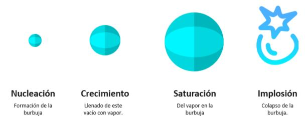
Figura 6. Cavitación inducida por ultrasonido.
