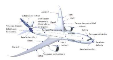
Figura 2. El avión de transporte y sus principales secciones estructurales.
