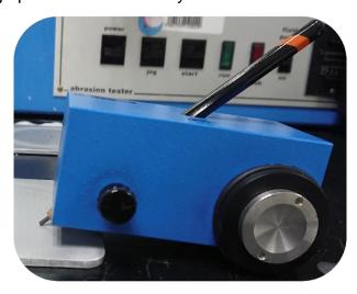
Figura 12. Equipo utilizado para el ensayo de dureza al lápiz.
