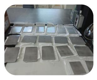
Figura 21. Sustratos metálicos con los materiales preparados PSR, PSRF, HPSR Y HPSRF.
