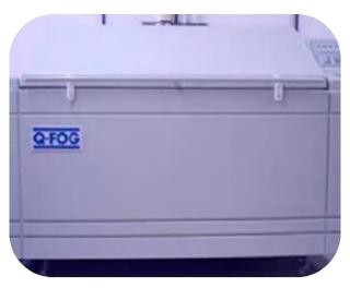
Figura 16. Equipo de niebla salina Q-FOG modelo 1100.
