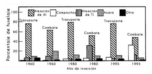
Figura 1. Dominio del aluminio en los fuselajes.
