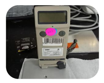
Figura 23. Medidor de espesores Positector 6000.
