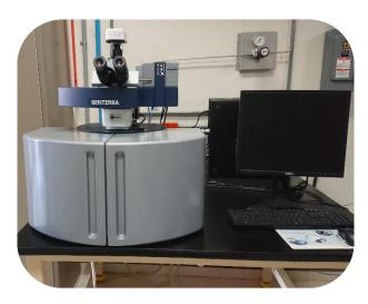
Figura 10. Raman dispersivo marca BRUKER modelo SENTERRA.
