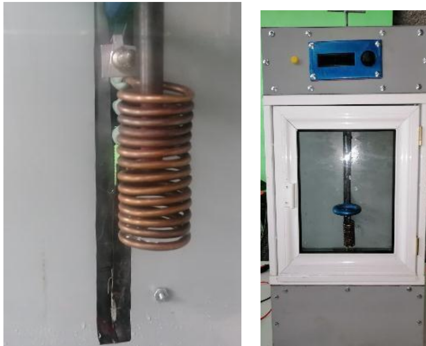
Figura 7.4. Temple de probetas.
