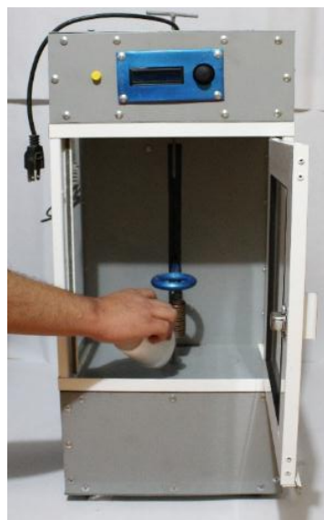
Figura 6.11. Llenado del depósito de refrigerante.
