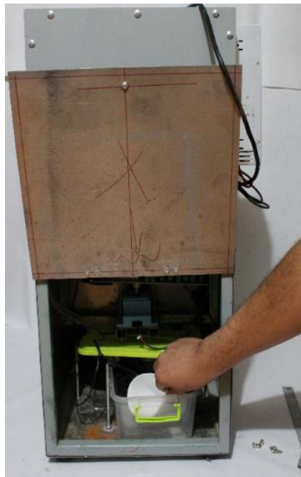
Figura 6.12. Vaciado del depósito de refrigerante.
