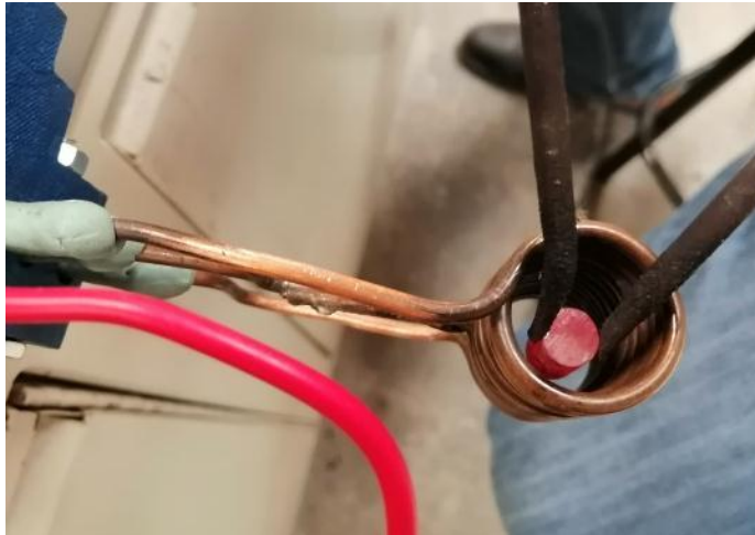
Figura 7.6. Calentamiento de probetas en el circuito separado.
