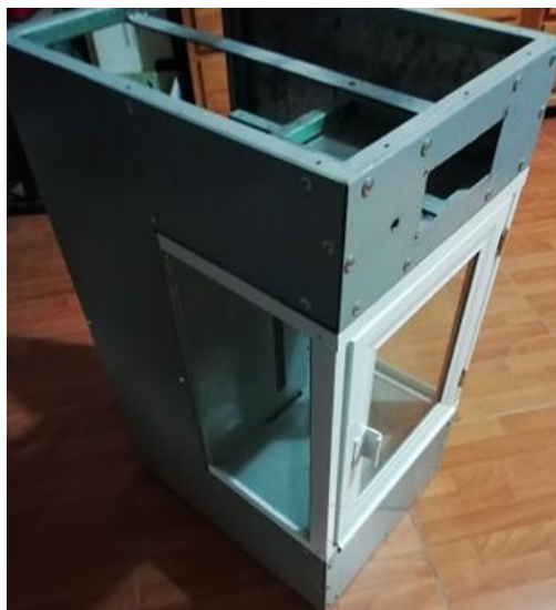
Figura 6.2. Estructura con protección y chapas metálicas.
