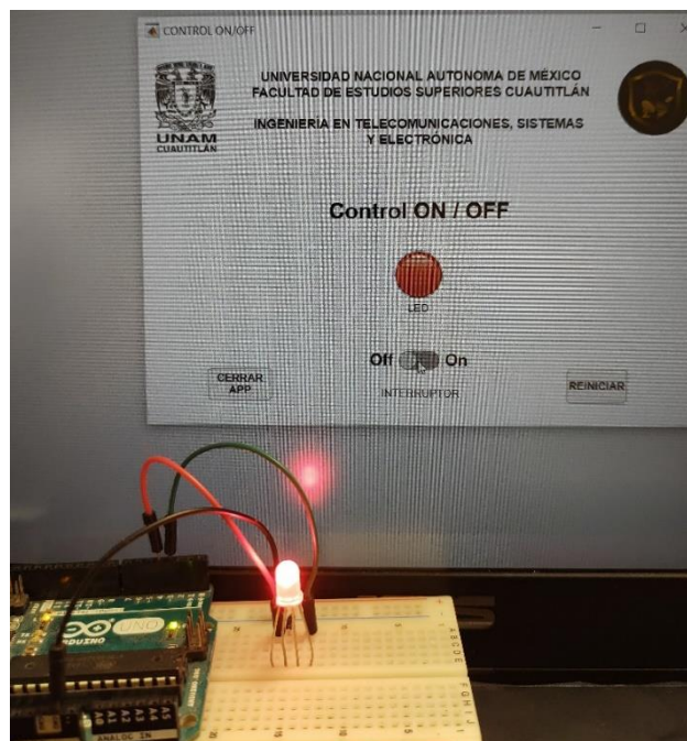
Fig. 3.11 Implementación del sistema: estado del interruptor = Off.
