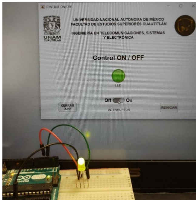
Fig. 3.9 Implementación del sistema: estado del interruptor = On.
