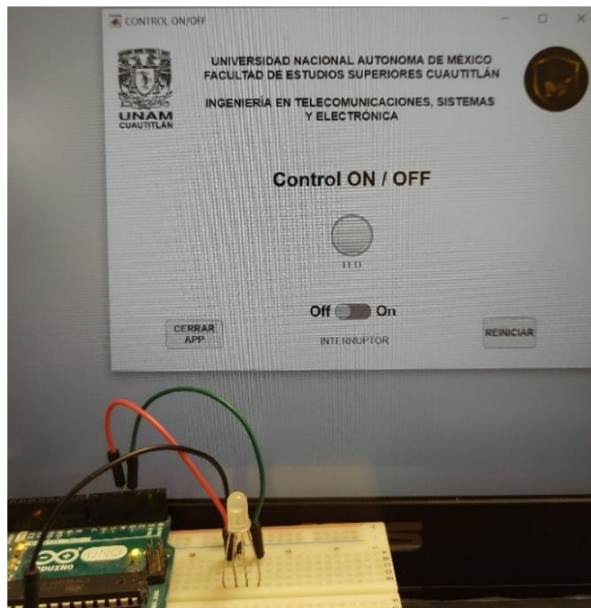
Fig. 3.7 Implementación con un LED RGB y el programa iniciado.
