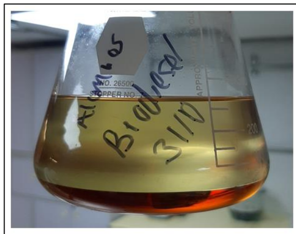
Figura 4.2 Muestra de biodiésel con glicerina
