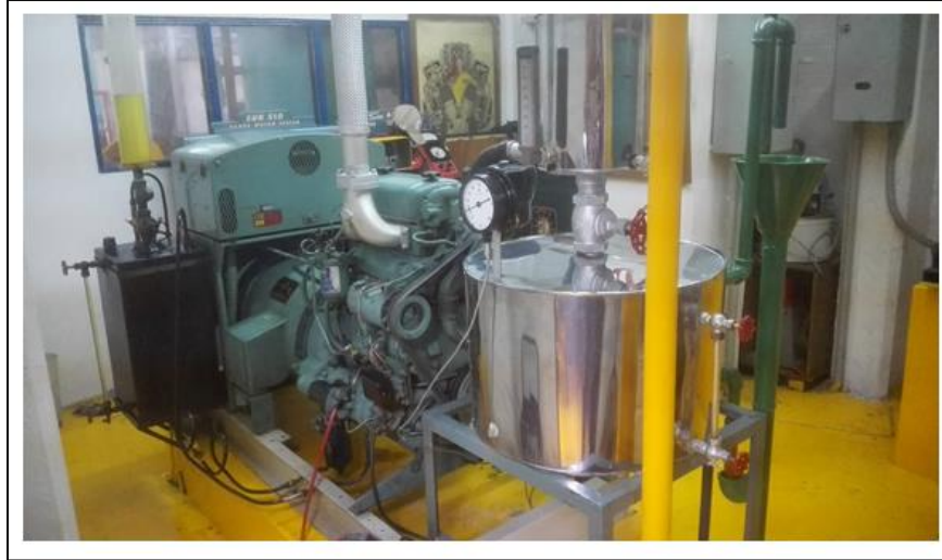
Figura 3.1 Conjunto generador, con motor GMC diésel, modelo 2150 (vista isométrica)
