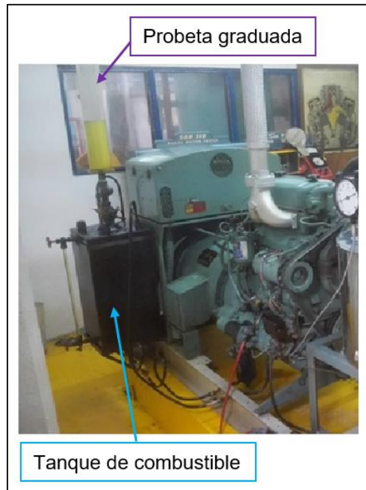
Figura 4.3 Ubicación del tanque de combustible y probeta del motor GMC 2150
