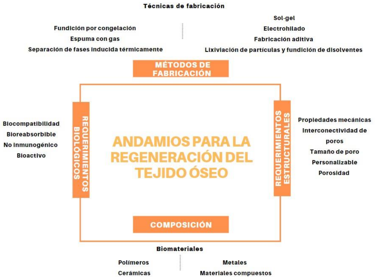
Figura 2. Esquema con las características necesarias para la fabricación de un andamio para la regeneración del tejido óseo. Fuente propia.
