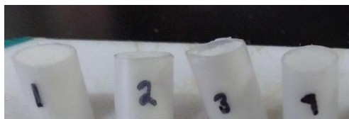
Figura 6. Andamios de PCL fabricados por medio de la técnica de lixiviación de sal de acuerdo, clasificados en cuatro grupos de acuerdo a las 4 condiciones descritas.
