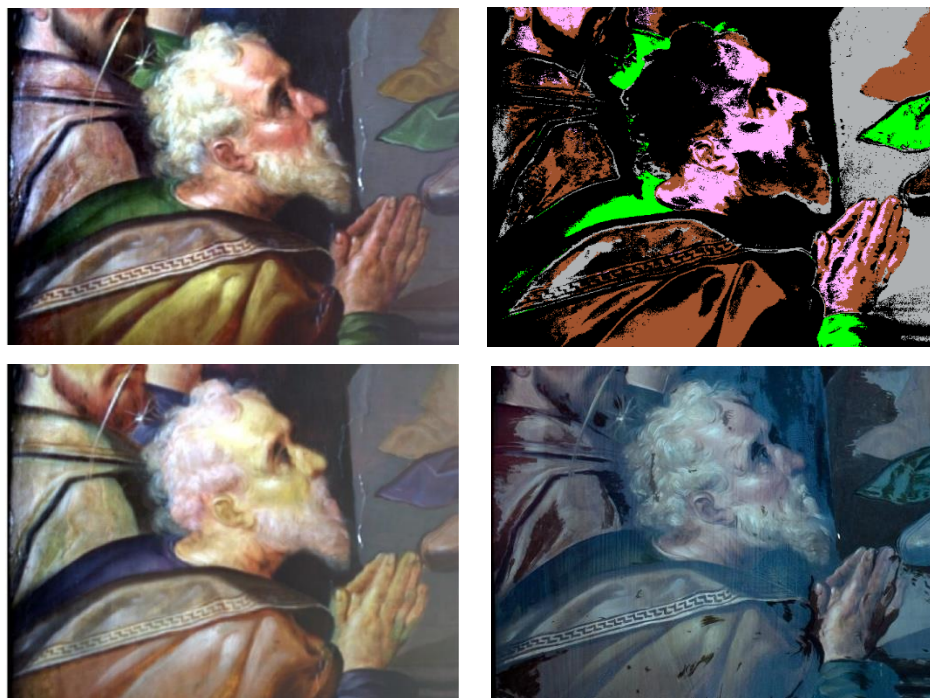
Figura 4.7.2. (Izquierda arriba) Imagen visible, (derecha arriba) imagen clasificada SAM. (Izquierda abajo) Imagen pseudo color IR. (derecha abajo) Imagen fluorescente inducida por UV.
