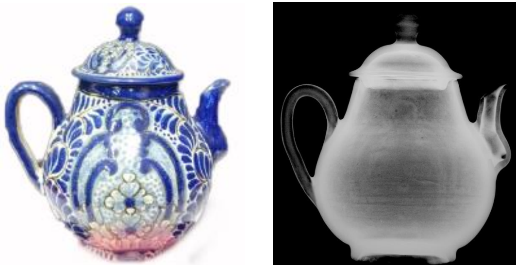
Figura 3.1.6 Radiografía digital de cerámicas, se puede observar algunas características estructurales, detalles de manufactura, estado de conservación del objeto.
