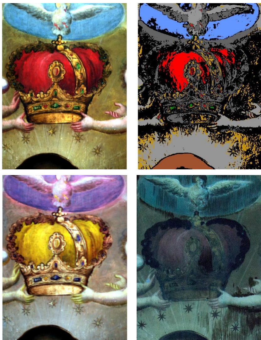
Figura 4.8.6 (Izquierda arriba) Imagen visible, (derecha arriba) imagen clasificada SAM. (Izquierda abajo) Imagen pseudo color IR. (derecha abajo) Imagen fluorescencia inducida por UV en el visible.
