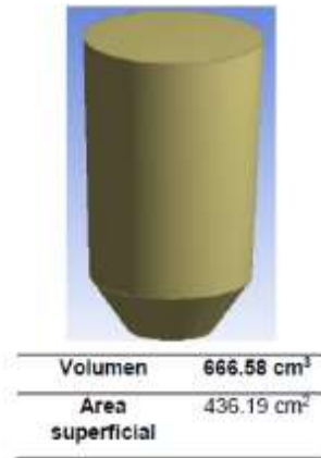
Figura 20 Área y volumen del alimentador. [ 5]
