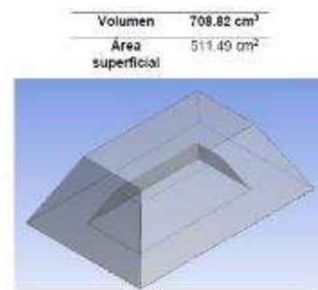
Figura 18. Módulo de solidificación 1. [5]
