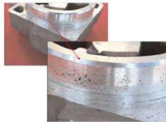
Figura 12. Poros causados por hidrogeno disuelto en pieza de aluminio.
