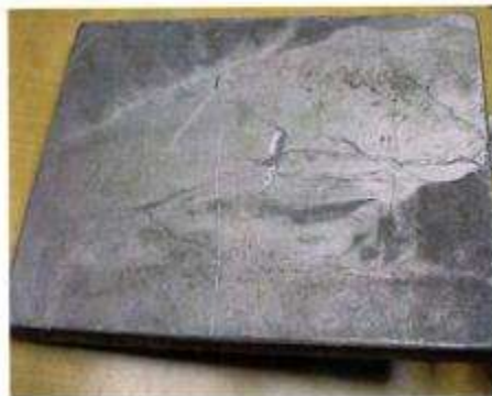
Figura 5. Sobredimensionamiento causadas por la falla de una placa modelo.
