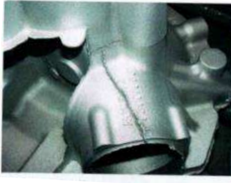
Figura 4. Fisura de un molde de arena.
