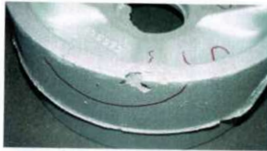
Figura 9. Agujero causado por arena suelta.
