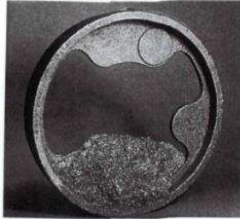
Figura 6. Gota causada por molde débil en arena verde.
