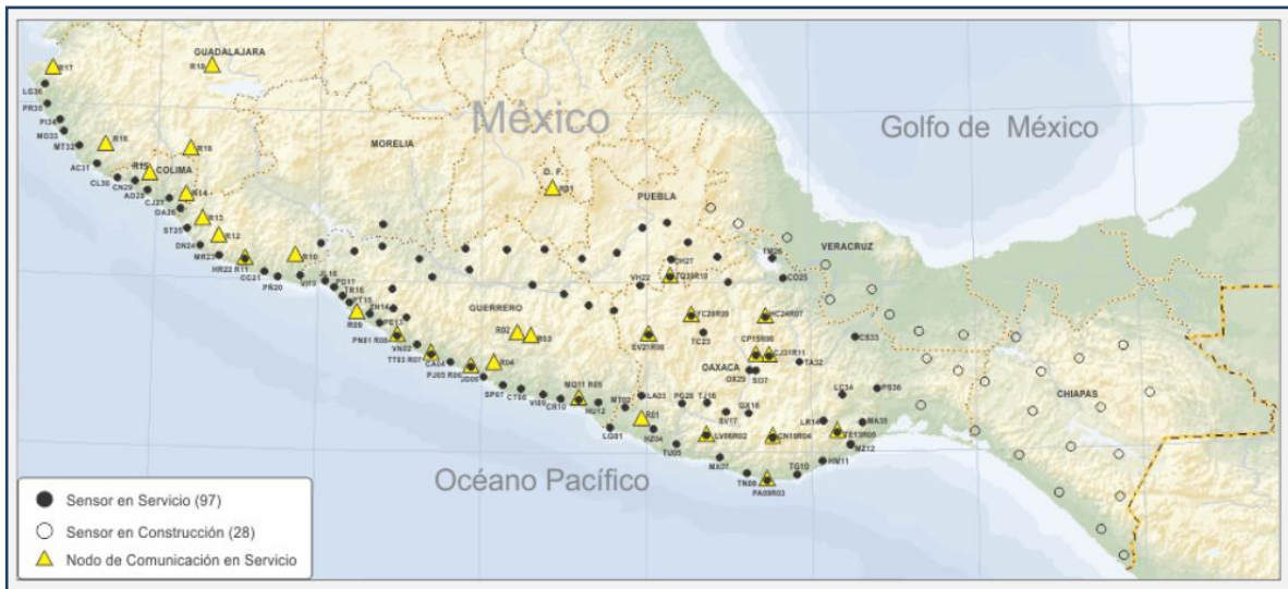
Fig. 23 Localización de sensores sísmicos del SASMEX Fuente: Centro de Instrumentación y Registro Sísmico, A. C., (2018).
