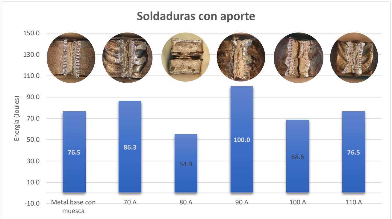
Figura 61. Resultados de resistencia al impacto en soldaduras GTAW con material de aporte. Energía (Joules) vs Probeta ensayada.
