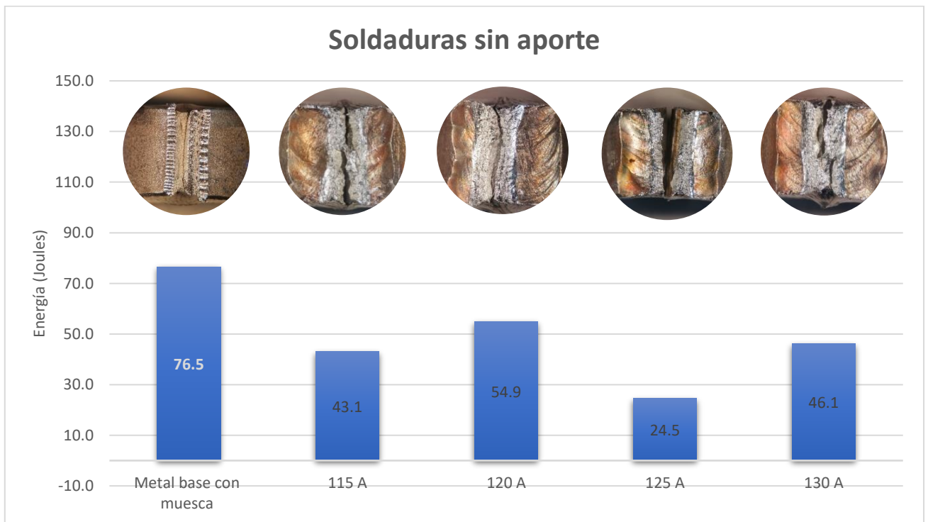
Figura 62. Resultados de resistencia al impacto en soldaduras GTAW sin material de aporte. Energía (Joules) vs Probeta ensayada.
