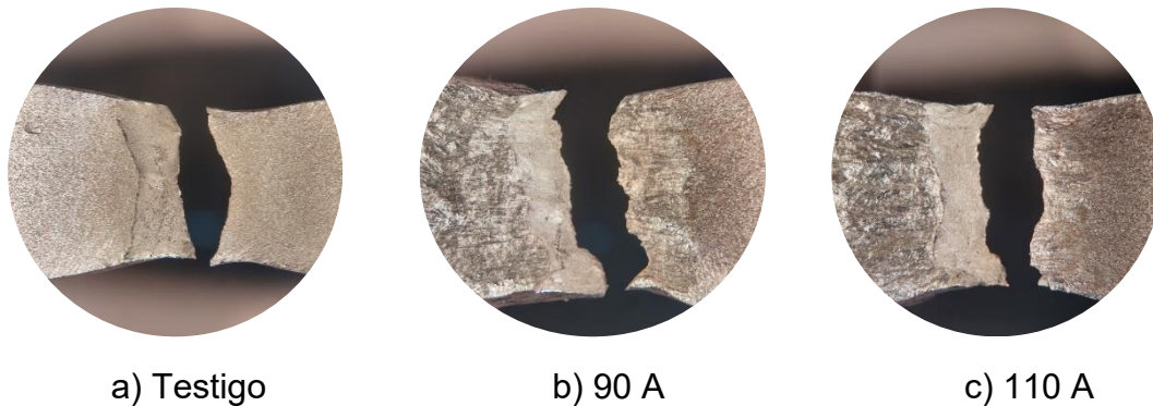
Figura 63. Fracturas de interés de las soldaduras heterogéneas: a) Testigo; b) 90 A; c) 110 A.
