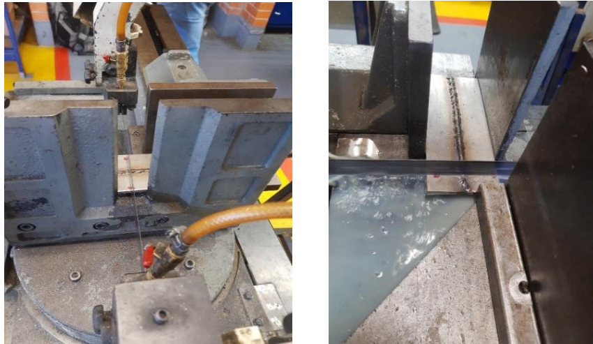
Figura 26. Proceso de corte de las probetas utilizando cizalla eléctrica con lubricante.
