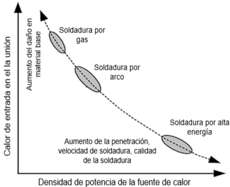
Figura 6. Densidad de potencia de la fuente de calor respecto al calor de entrada [8].
