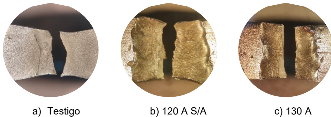
Figura 64. Fracturas de interés de las soldaduras homogéneas: a) Testigo; b) 120 A; c) 130 A.
