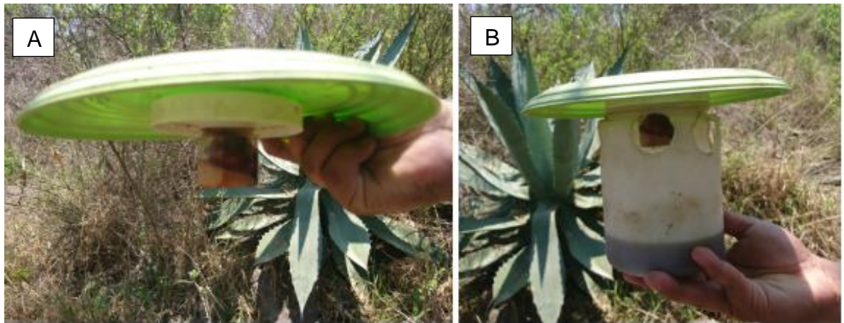
Figura 2. Diseño de la trampa tipo NTP-80 modificada cebada con calamar. A). Tapa con el cebo. B). Trampa armada.
