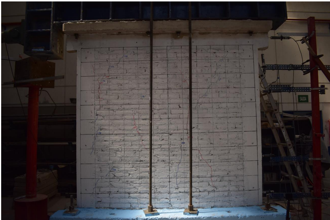
Figura 139. M-5 a \delta = 0.002 . Grieta pico: 1.5 mm, grieta residual: 0.8 mm.
