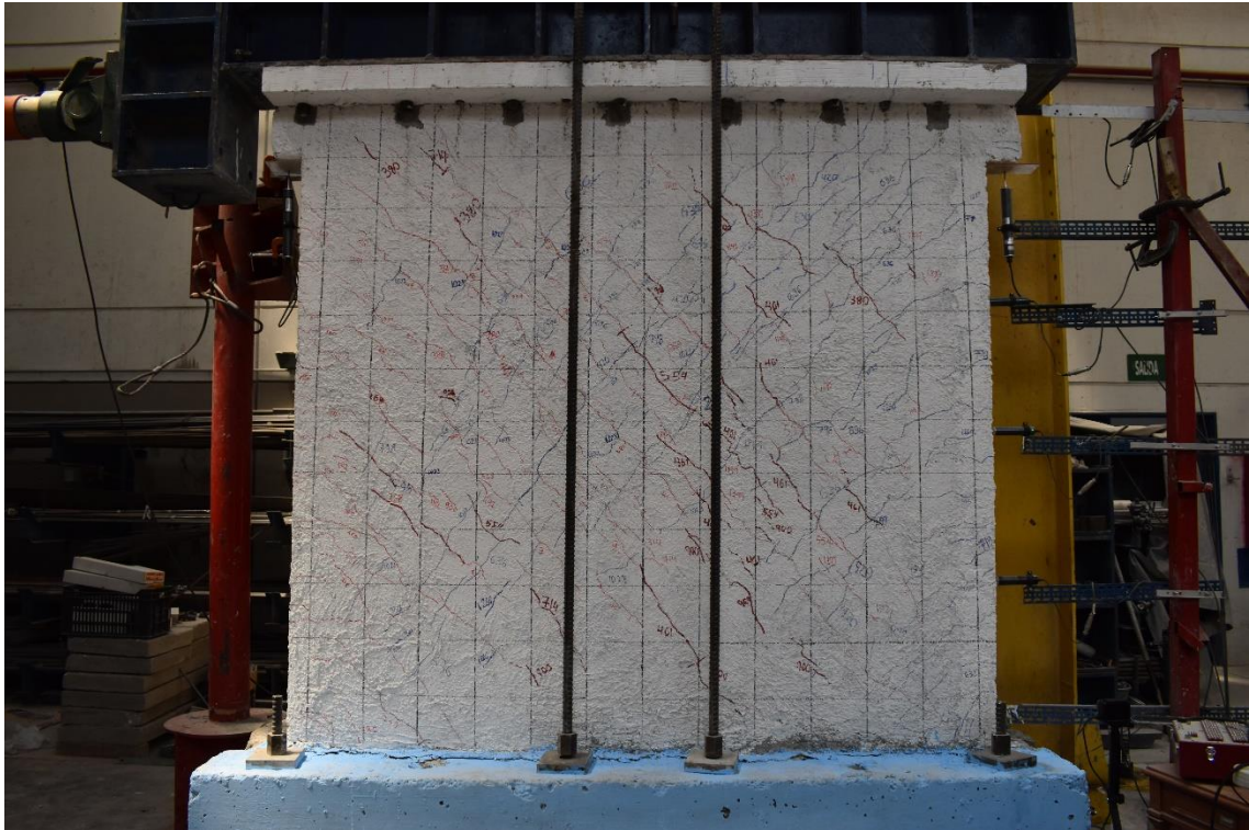
Figura 134. M-3R a \delta = 0.005 . Grieta pico: 0.6 mm, grieta residual: 0.15 mm.
