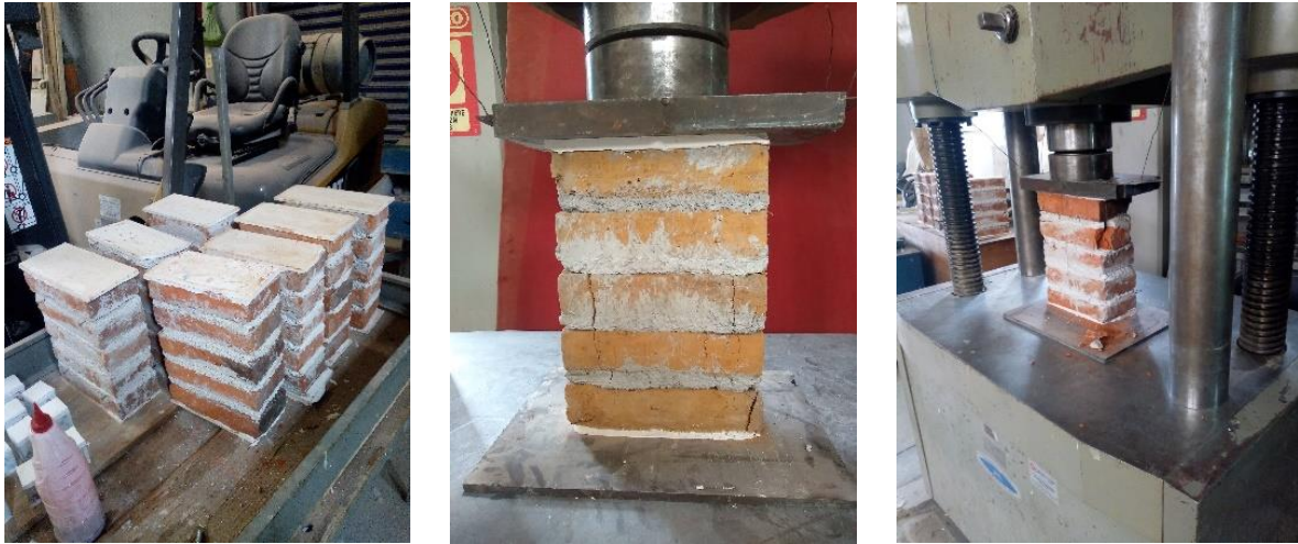
Figura 9 Ensayes a compresión de pilas de mampostería.
