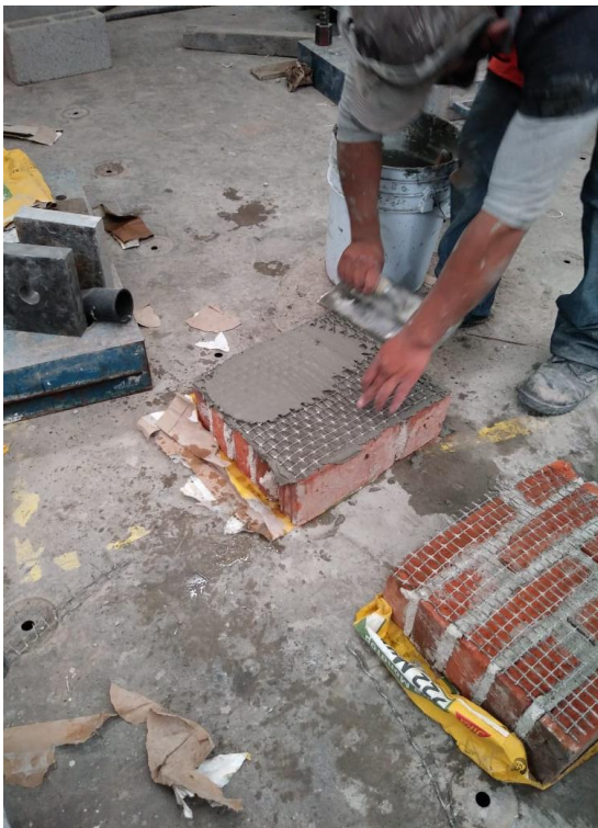
Figura 38. Aplanado de muretes con malla de fibra de vidrio para prueba a compresión diagonal.
