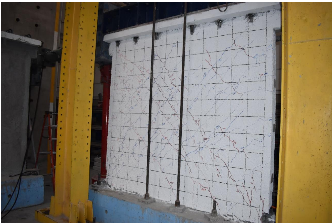
Figura 126. M-1R a \delta = 0.005 . Grieta pico: 1.5 mm, grieta residual: 0.35 mm.
