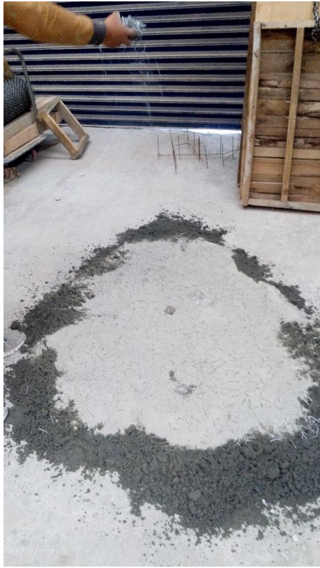
Figura 32. Mezclado del mortero con la fibra.
