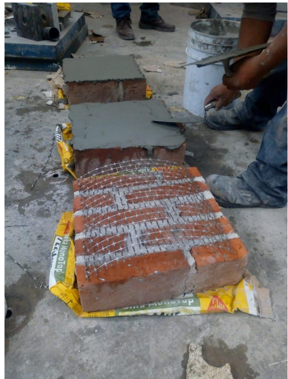
Figura 38. Aplanado de muretes con malla de fibra de vidrio para prueba a compresión diagonal.
