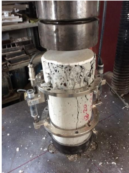
Figura 16 Probeta de concreto después de la prueba para la determinación del módulo de elasticidad.
