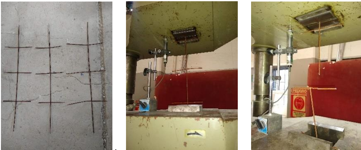
Figura 19 Ensayo a tensión de probetas de la malla electrosoldada.
