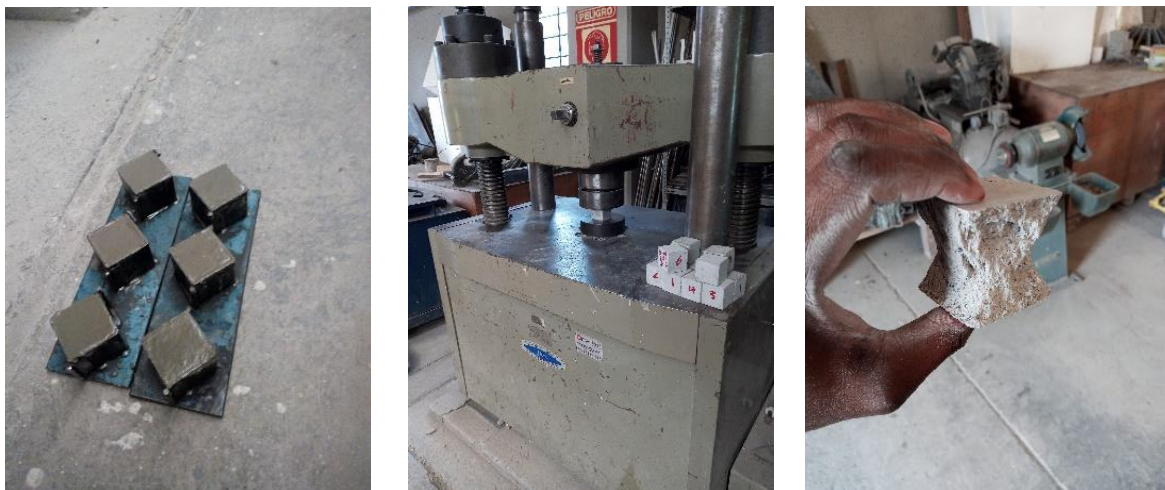
Figura 13 Ensayes a compresión de probetas de mortero.
