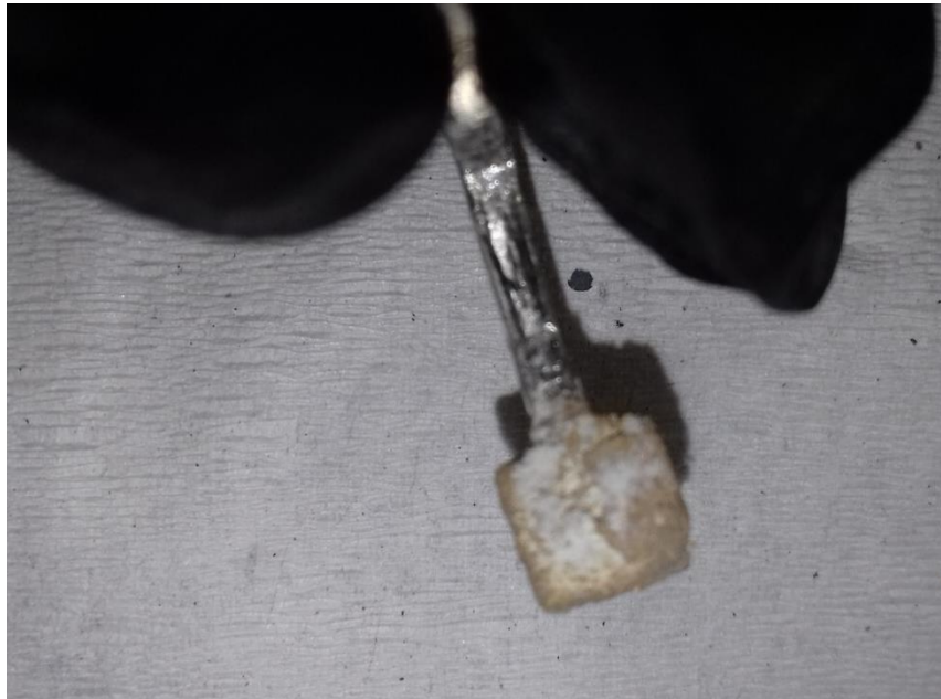
Figura 13. Electrodo de material tridimensional de ZnO_{(p)}
