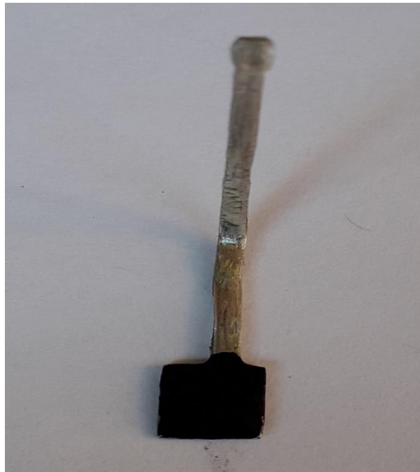
Figura 14. Electrodo con material bidimensional de ZnO_{(ca)} .
