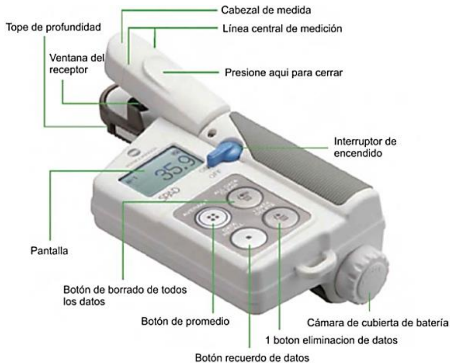
Figura 6. Componentes del medidor SPAD-502 Plus. (Tomado y modificado de Minolta, 2009).
