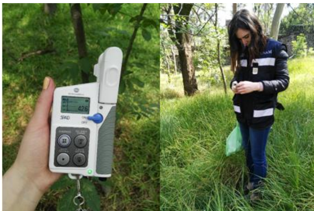
Figura 14. Obtención de lecturas y promedios con el medidor SPAD-502 Plus (Bosque de Tlalpan, 2019).
