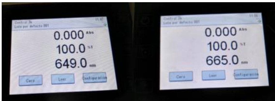
Figura 16. Calibración de longitudes de onda, 649 nm (clorofila b) y 665 nm (clorofila a).
