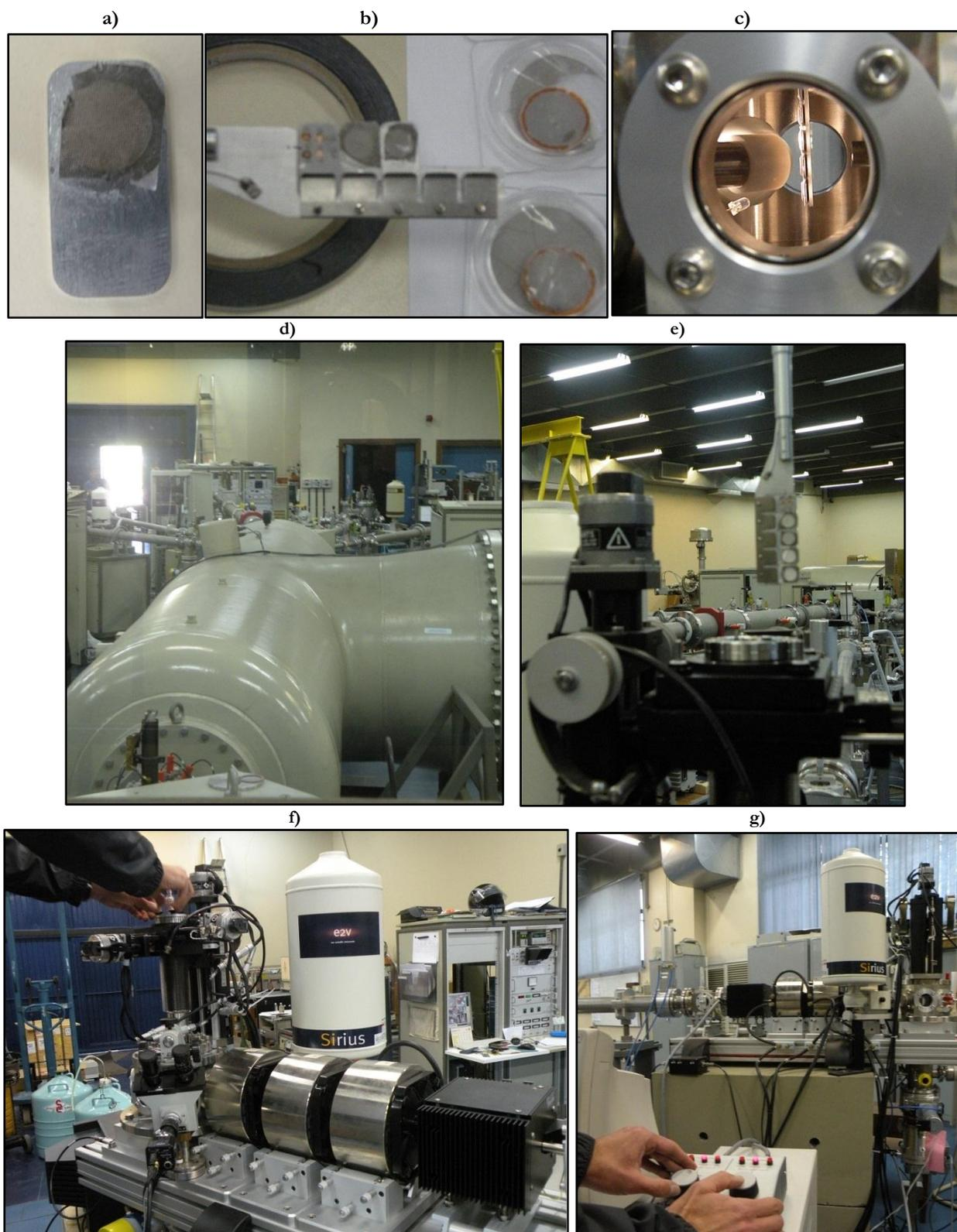
Figura 4.7. Colección de fotos del proceso de irradiación. a) Muestra seleccionada en rejilla. b) Porta-rejilla de muestras. c) Vista de muestra desde una ventana de la cámara de irradiación. d) Acelerador tipo Tándem de la UFRGS. e) Introducción de la rejilla en la cámara de irradiación. f) Microsonda de iones g) Selección manual de la región de la muestra a estudiar mediante la técnica de microPIXE.
