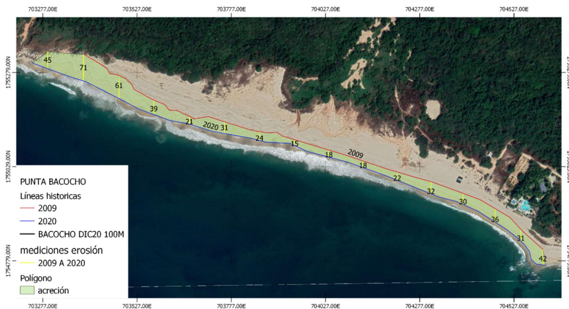
Figura 16. Mapa de procesos de erosión-acreción Punta Bacocho. Fuente: Elaboración propia con imagen base obtenida de Google Earth Professional.
