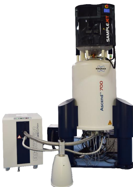
Figura 13. Espectrómetro Bruker Avance III HD de 700 MHz para ^1\text{H} (campo magnético de 16.44 T), equipado con una criosonda y un automuestreador “SampleJet”.
