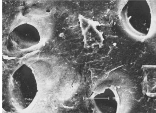
Imagen 16. Superficie PEEK tratada con ácido sulfurico al 98%.<sup>4</sup>
