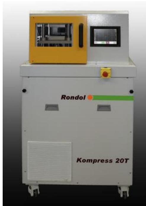
Imagen 8. Máquina de compresión para PEEK. <sup>5</sup>
