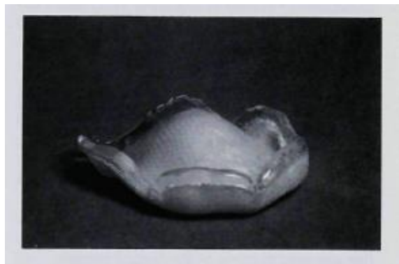
Fig. 9. Base de registro superior reforzada con 10 capas tratadas con plasma y fibra de polietileno trenzada. (Ladizesky et al 1994).
