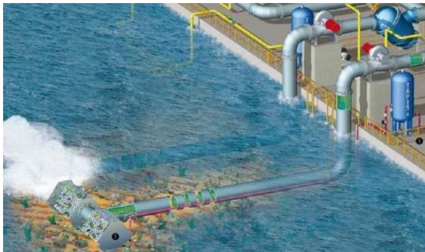
Figura 32. Obra de toma abierta (Piña, 2010)
