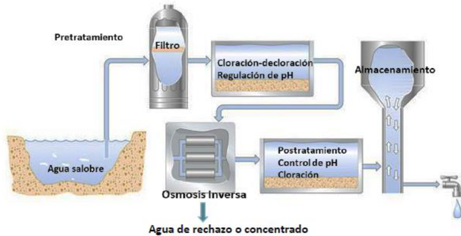
Figura 30. Diagrama general del proceso de ósmosis inversa (Los Vientos de Vaivén Maestro, A.C, 2018).
