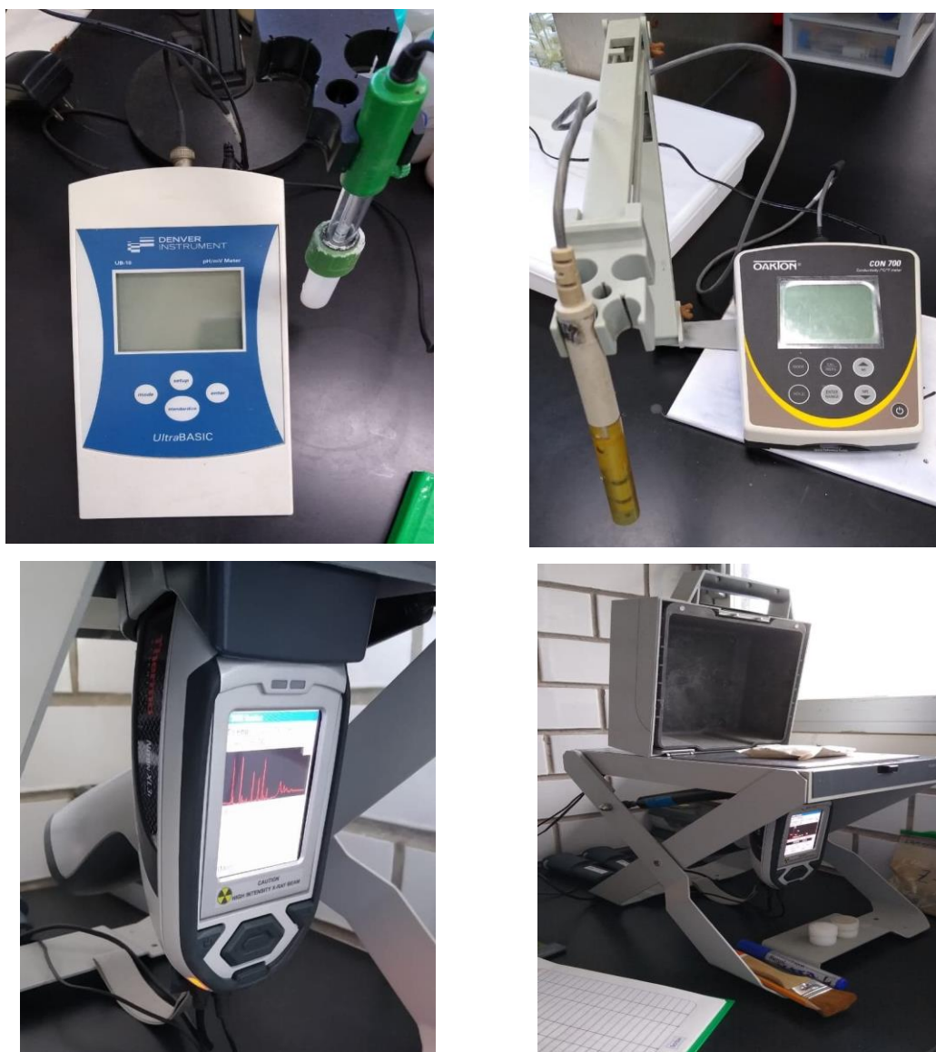
Figura 27. Equipo instrumental utilizado para el análisis de las muestras, Denver Instrument Ultrabasic (UB) 10 (arriba izquierda), OAKTON CON 700 (arriba derecha) y Niton XL3t Ultra (abajo).
