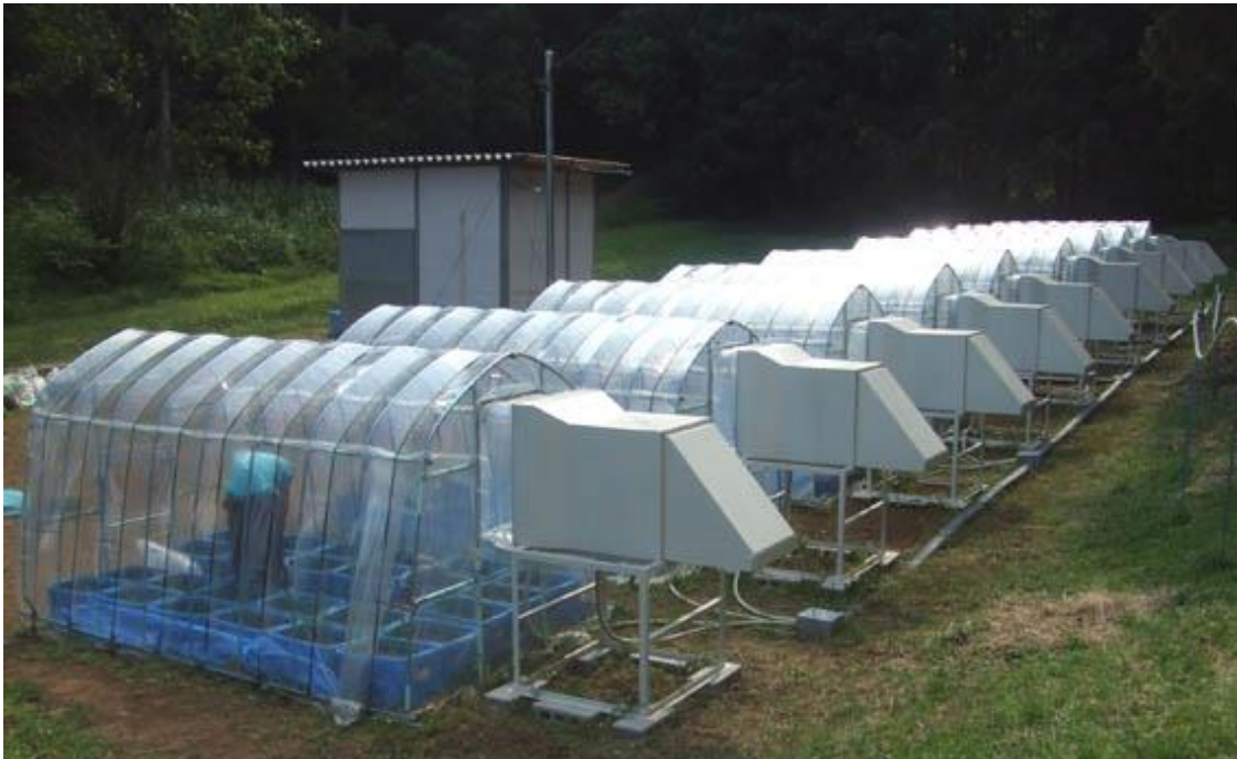
Figura 4. Cámaras experimentales empleadas para determinar el daño por ozono la vegetación de Japón. Fuente: http://web.tuat.ac.jp/~negitono/Research%20in%20Izuta%20Lab.html
