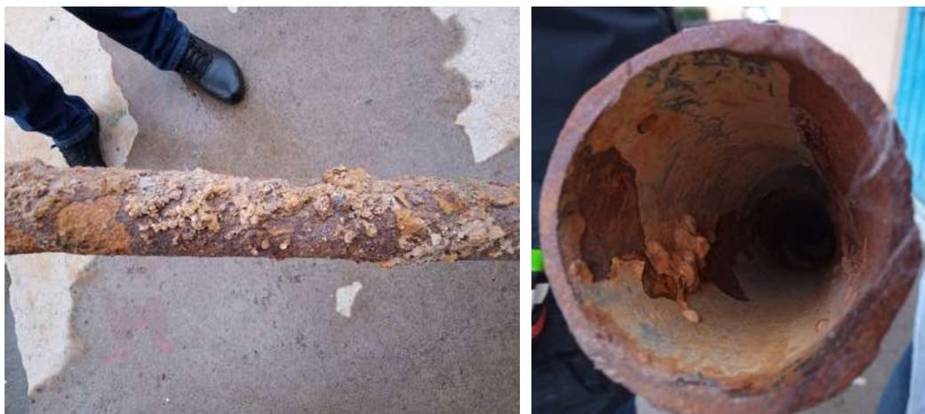
Figura 46. Tubería con corrosión.
