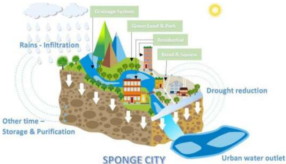
Figura 7. Esquema del funcionamiento general de una Ciudad Esponja [Imagen de (Shun Chan, 2018)]
