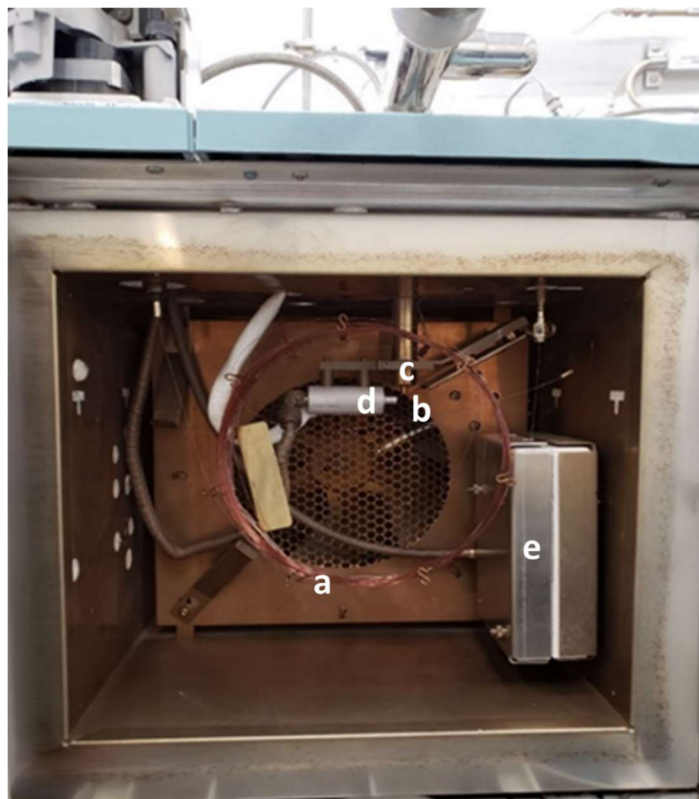
Figura 10. Cromatógrafo de gases Agilent Technologies 6890 configurado para CG×CG. a: primera columna, b: segmento de retraso, c: propulsor frío, d: propulsor caliente y e: horno de la segunda columna.
