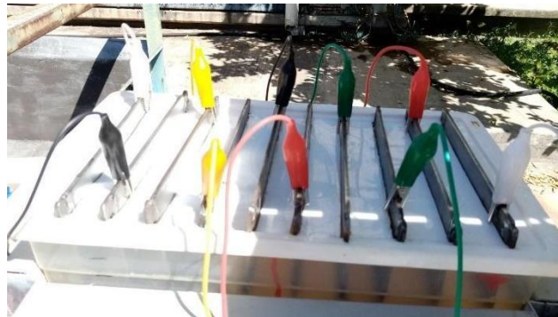
Ilustración 4. Colocación de los caimanes en las placas de hierro (electrodos)
