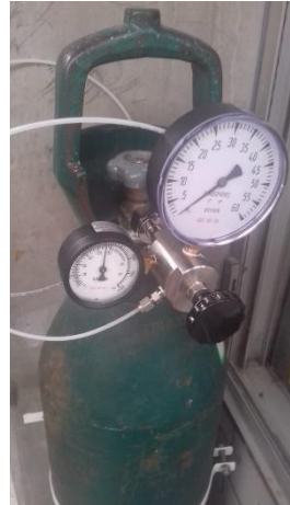
FIG. 2 Conexión de la manguera al tanque de oxígeno
