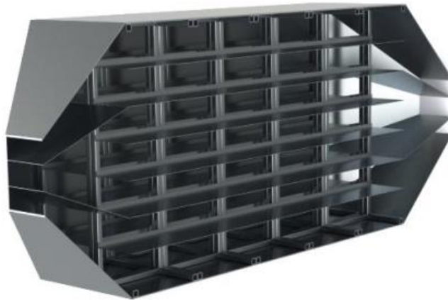
Ilustración 37 Corte transversal de la cámara de secado de café (Garduño, 2021)
