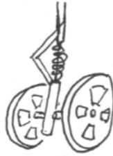
Figura 4.16: Tren de aterrizaje delantero: amortiguador con doble rueda.
