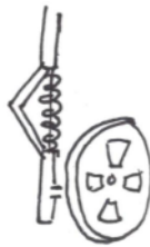
Figura 4.17: Tren de aterrizaje delantero: amortiguador con una rueda.
