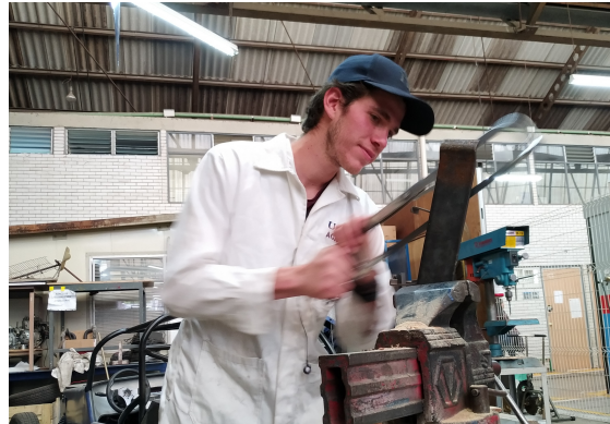
Figura 4.79: Corte de solera de acero para carga útil. (Mazariegos, 2018).
