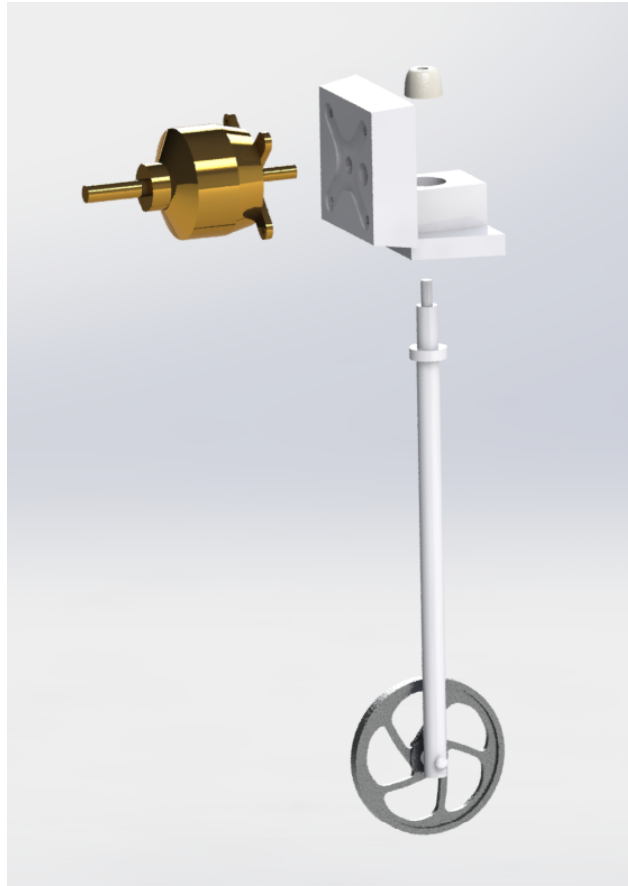
Figura 4.48: Ensamble pared de fuego con tren de aterrizaje delantero y motor.
