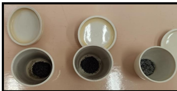
Figura 9. Residuos de muestra en la determinación de la materia volátil.
