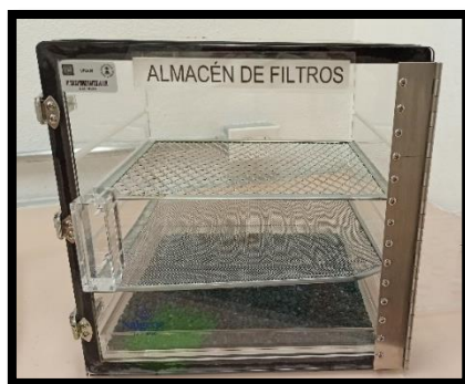
Figura 27. Almacén de filtros.
