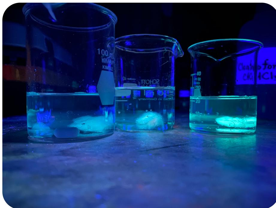
Figura 4.33.- Hidrogeles copolímeros de poli[(PEG-MEA)-co-(mAc-PAC)] en soluciones metanol/agua 1:1. De izquierda a derecha: Solución de  $\text{CuBr}_2$ , sin presencia de especies metálicas, solución de  $\text{ZnCl}_2$ . Irradiación UV a 356 nm.
