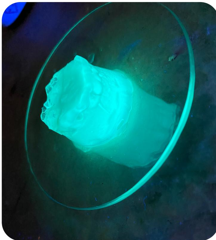
**Figura 4.28.- Hidrogel de poli[(PEG-MEA)-co-(mAc-DAC)] después del proceso de hinchamiento en solución de metanol/agua 1:1. La fuerte emisión fluorescente se observó ante una longitud de onda de irradiación UV a 356 nm.**
