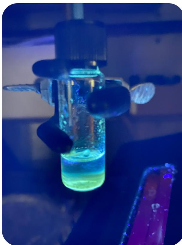
**Figura 4.25.-** Reactor de polimerización frontal para la síntesis de hidrogeles copolímeros. Se muestra la mezcla de acrilato de polietilenglicolmetiléter (PEG-MEA) y metaacrilildietilaminocumarina (mAc-DAC) irradiada con luz UV a 356 nm.
