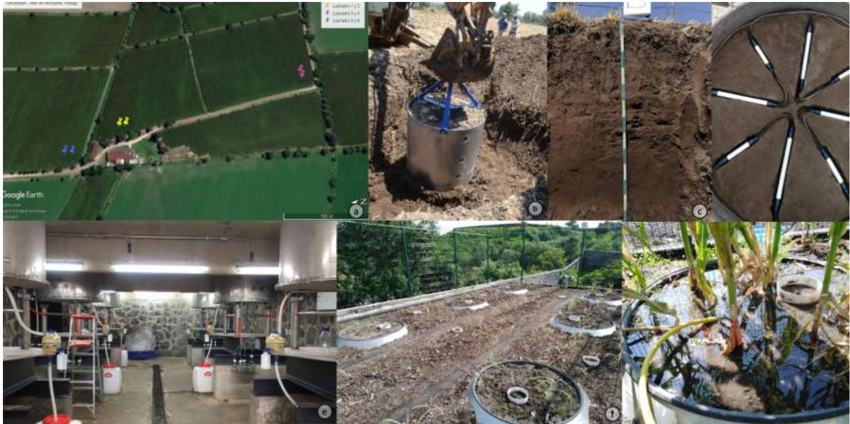
Figura 4.- Zona de estudio e instalación de lisímetros. a) Ubicación de la zona de estudio y puntos de extracción de los lisímetros (puntos en amarillo, rosa y azul); b) Procedimiento para la extracción de lisímetros con ayuda de maquinaria pesada; c) Ejemplo de perfil de suelo descrito (descripción edafo-ecológica); d) Condición frontera del lisímetro establecida a partir del arreglo de cápsulas de succión; e y f) Vista inferior y superior de la estación de lisímetros del Instituto de Geología de la UNAM; g) Riego de lisímetro.
