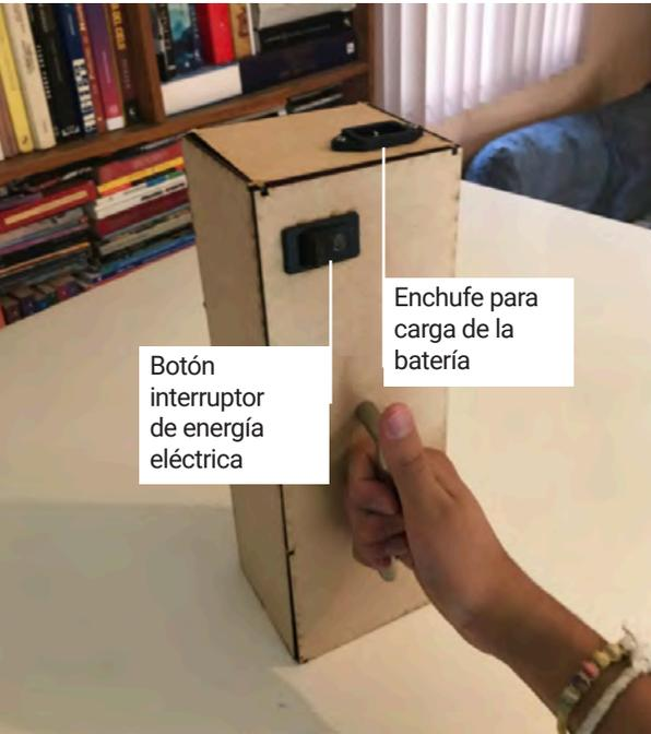
Figura 4.39 Simulador de MDF para la carcasa de la batería con los elementos que integraron el módulo.
