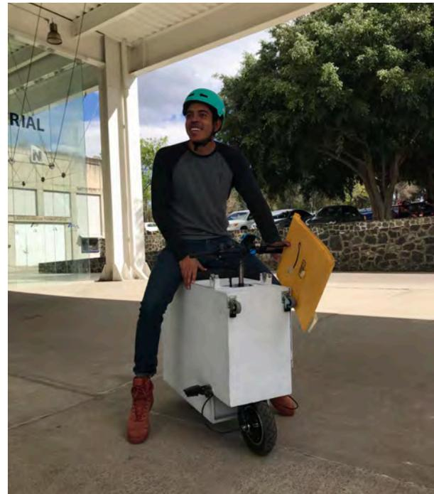
Figura 2.42 La altura del prototipo y el cambio en el ángulo de lanzamiento disminuyó la sensación de perder el equilibrio durante las pruebas.
