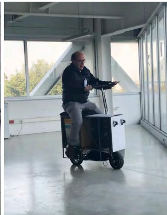
Figura 2.30 Primer prototipo de VUM y pruebas con usuarios del Centro de Ingeniería Avanzada de la Facultad de Ingeniería.
