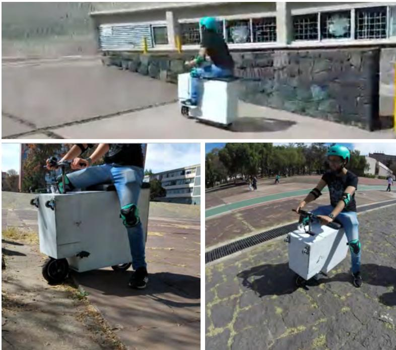
Figura 2.43 Pruebas en rampas y en terrenos irregulares como empedrados.
