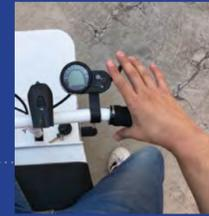
7. Al frenar, el usuario usa la palanca con la mano izquierda, lo cual activa el freno en la llanta trasera del vehículo.
