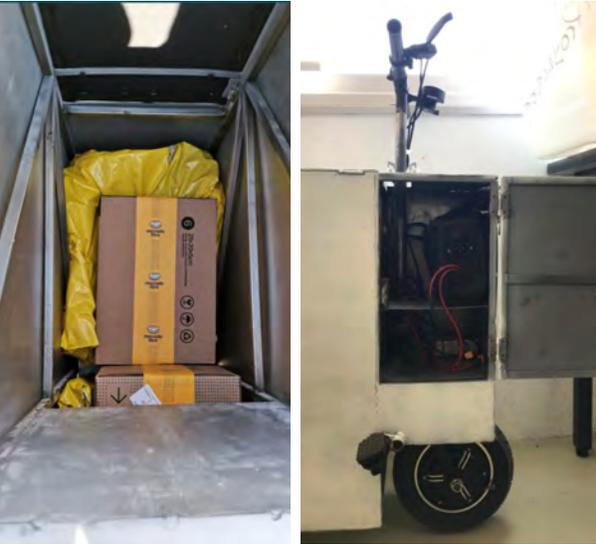
Figura 2.37 En la izquierda, vista interior del compartimiento para paquetes; en la derecha, acceso al sistema para mantenimiento.
