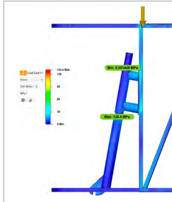
Figura 5.8 Esfuerzo de Von Misses máximo (130.4 [MPa]) identificado en la cuerda de la horquilla.
