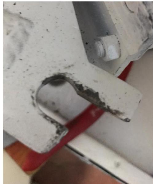
Figura 5.12. Desgaste en los soportes del eje trasero.
