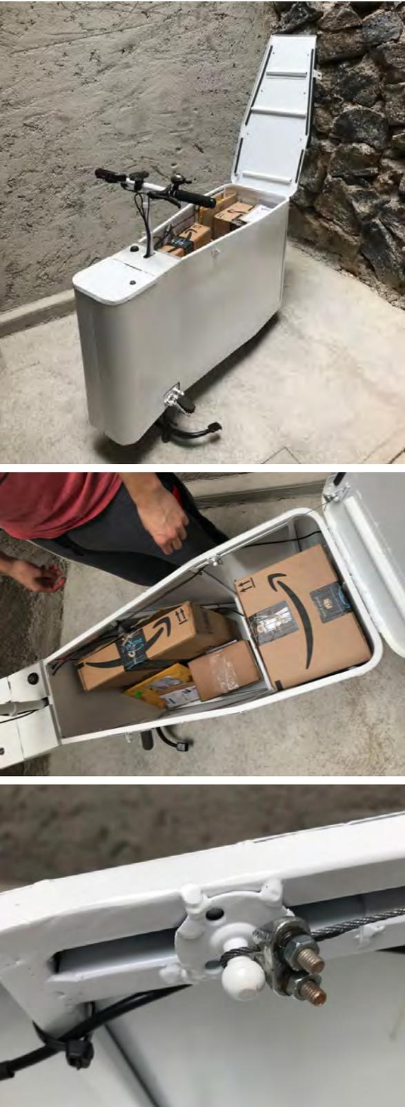
Figura 4.78 Cable tensionado para sostener la puerta del contenedor para paquetes.
