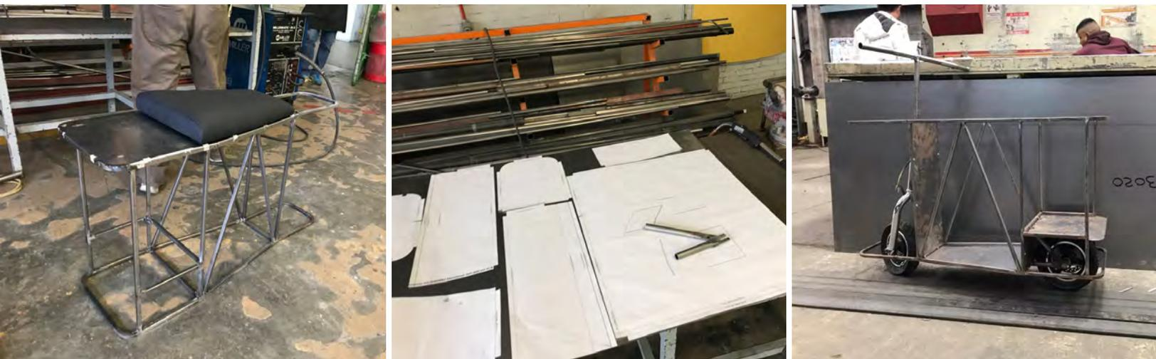
Figura 4.62 Construcción del prototipo como parte de la primer etapa de manufactura.
