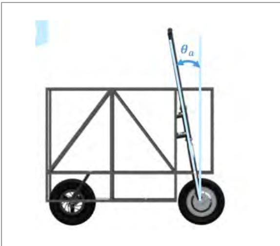
Figura 2.29 Ángulo de lanzamiento ( $\theta_a$ ) para la dirección de VUM (López, 2020).
