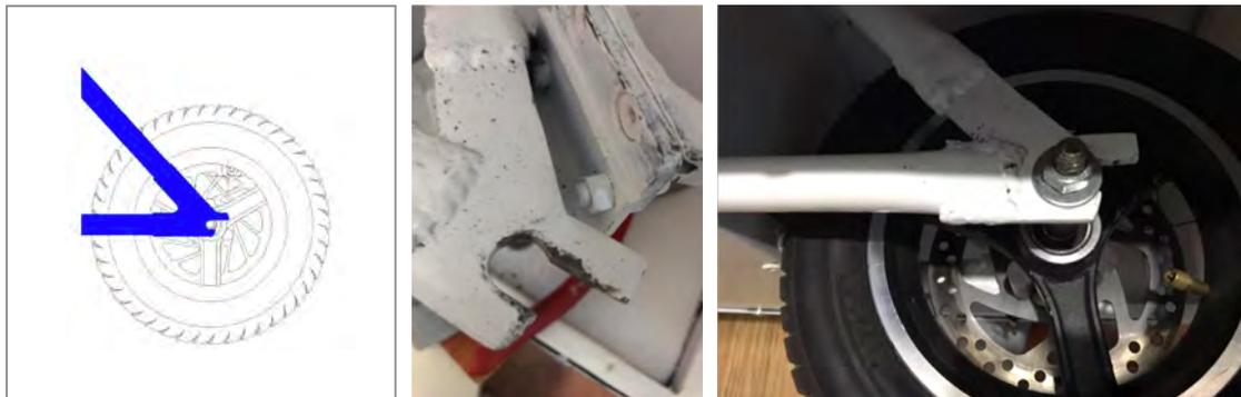
Figura 4.76 La geometría del soporte para el eje trasero provocó que la llanta saliera de su posición original como resultado del impacto con una superficie irregular.
