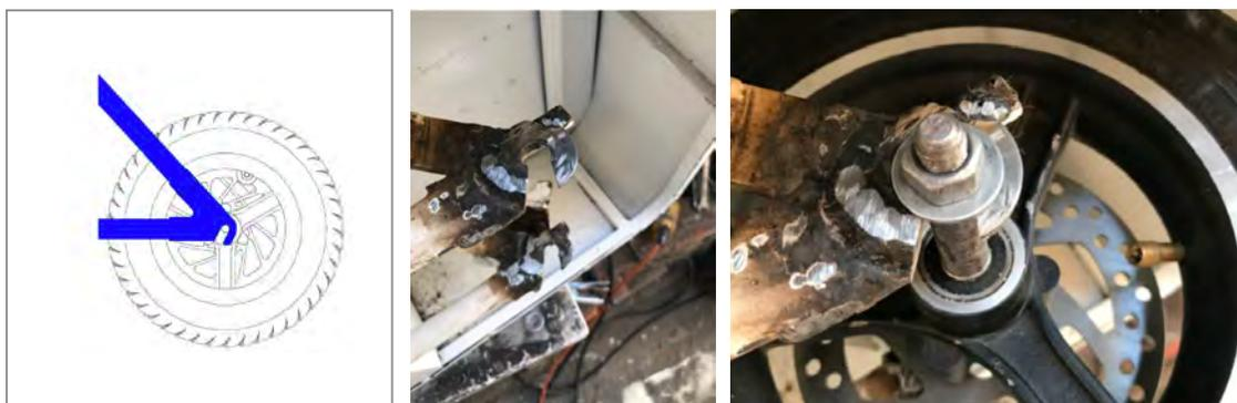
Figura 4.77 Modificación implementada sobre el soporte trasero.
