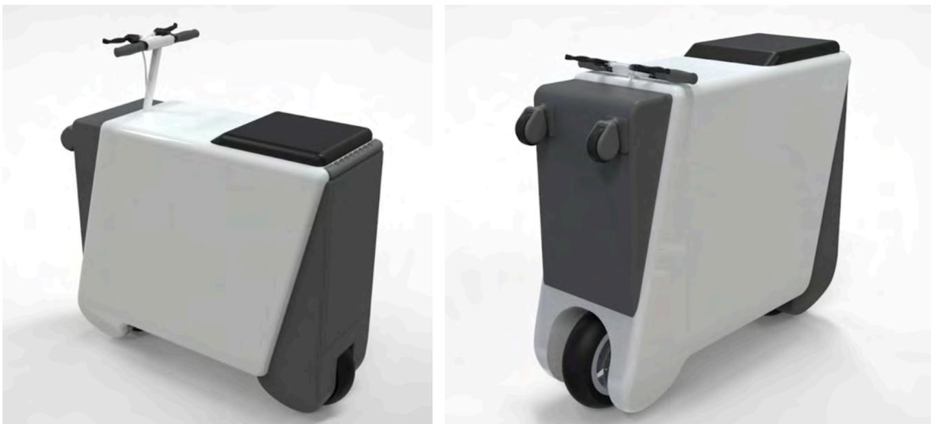
Figura 2.35 VUM en modo vehículo. A la derecha se muestra el pliegue del manubrio, las llantas de 10 in ocultas y las llantas de 2 in al frente para mover el objeto en modo maleta.
