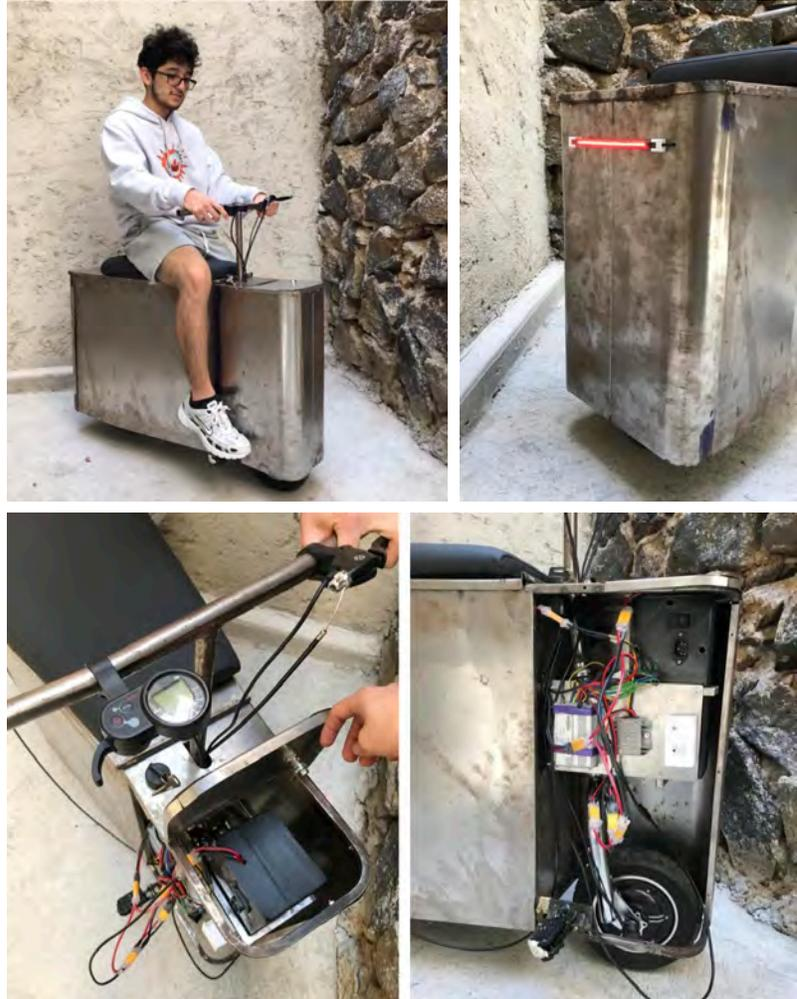
Figura 4.66 Integración de todas las piezas, incluyendo los componentes eléctricos y electrónicos del VUMi3.
