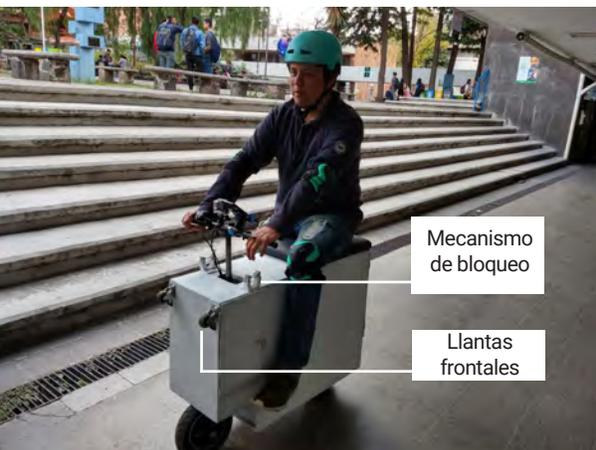
Figura 2.38 Llantas frontales de 2 in de diámetro y mecanismo para bloquear el movimiento del manubrio.
