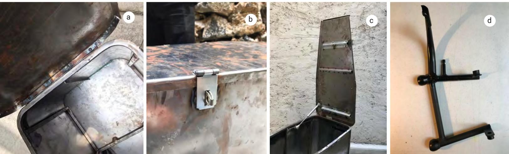
Figura 4.65 Soldado de la bisagra de piano en la parte posterior del vehículo (a), colocación del grillete para el candado (b), colocación del pistón para mantener abierto el compartimiento de paquetes (c), manufactura de la pieza parador (d).
