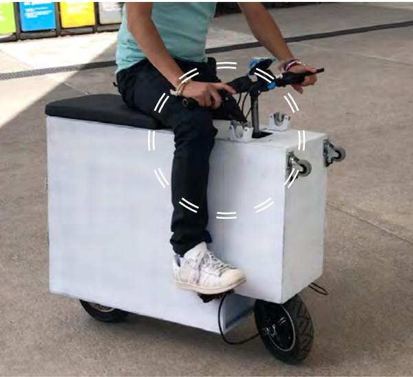
Figura 4.6 Reducción en el ancho de la parte frontal del vehículo para garantizar la comodidad del usuario durante los trayectos.
