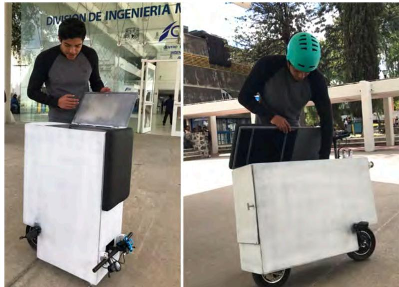
Figura 2.40 Acceso al contenedor de paquetes por la parte posterior del vehículo y por el asiento.
