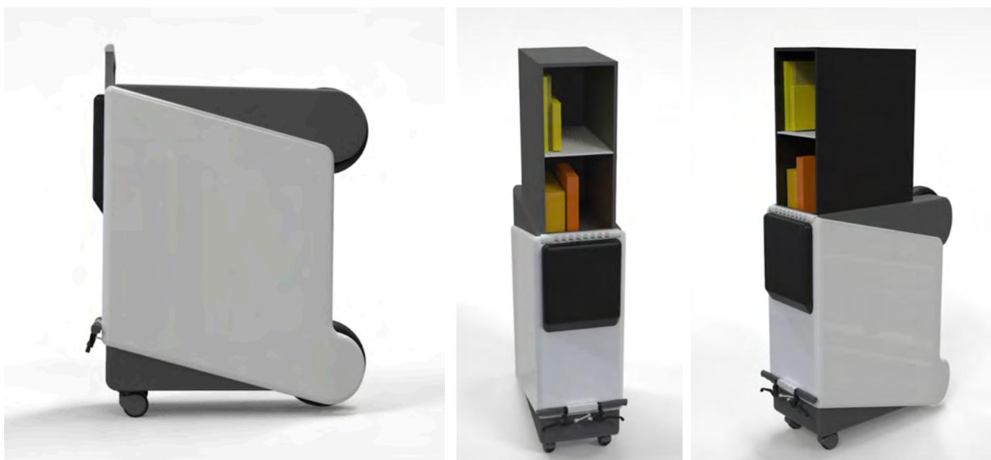
Figura 2.36 VUM en modo maleta. A la derecha se muestra como se tiene acceso a los paquetes.
