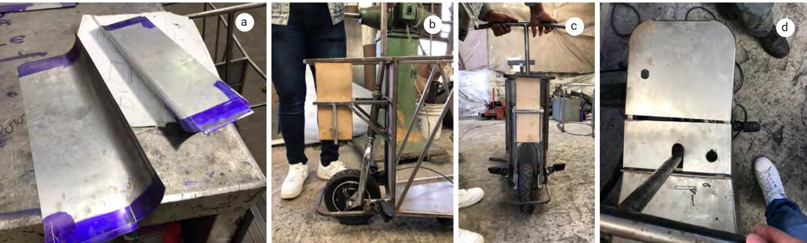
Figura 4.63 Segunda etapa de manufactura para el prototipo de VUMi3: Rolado de láminas (a), soporte para el módulo de la batería (b,c), láminas frontales (d).
