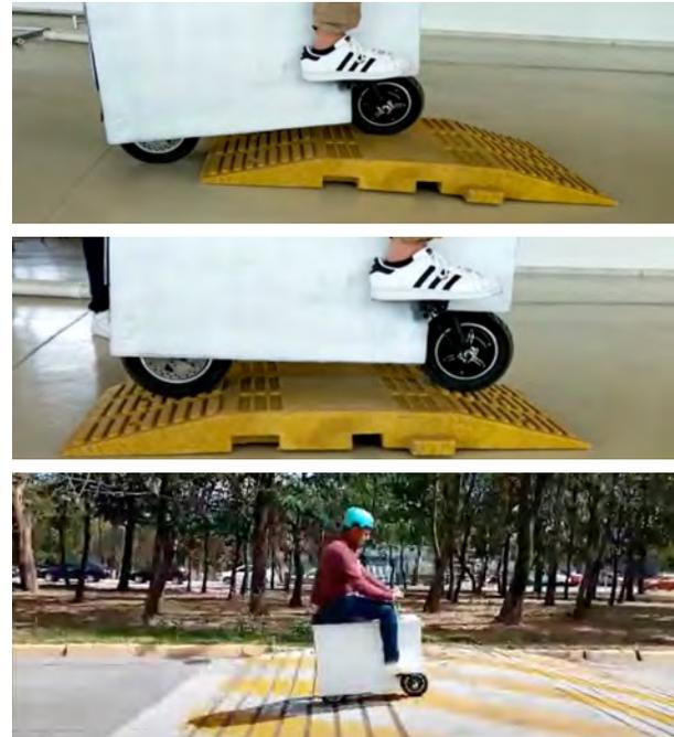
Figura 2.41 Pruebas del vehículo en topes de concreto y polietileno.
