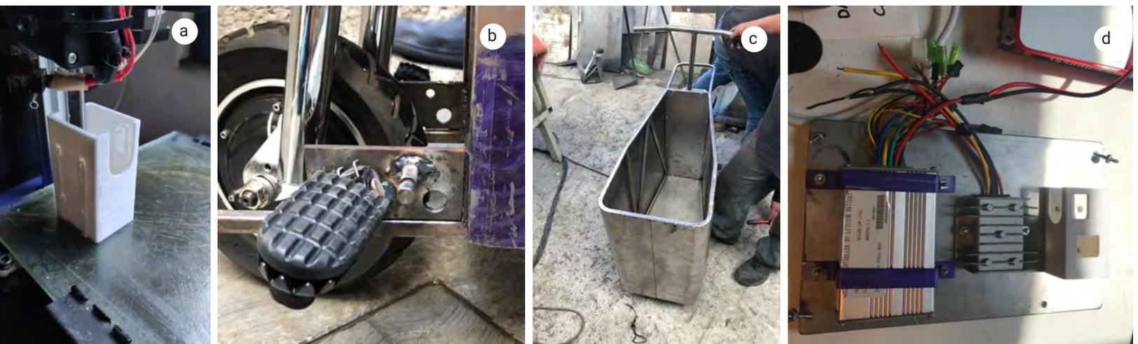
Figura 4.64 Manufactura aditiva de las piezas utilizando PLA (a), colocación del reposapiés (b), colocación del sistema envolvente (c) y elaboración de la platina para los componentes electrónicos (d).
