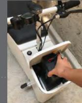
5. El usuario conecta la batería al resto del vehículo a través del conector amarillo.
