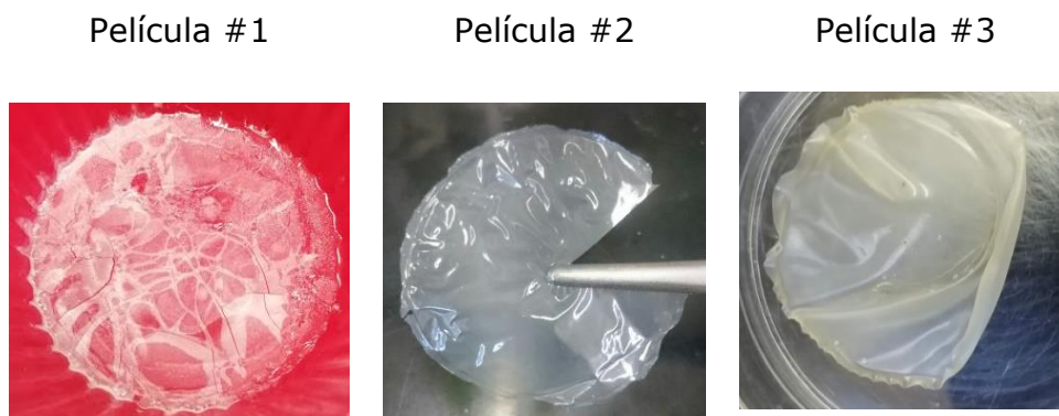
Figura 51. Películas elaboradas a base de NIPAM (Película #1), NIPAM/Alginato al 3% (Película #2) y Alginato al 3% (Película #3), para prueba de captación de agua.
