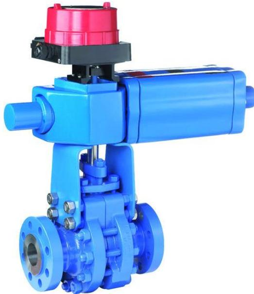
Fig.1.4 Válvula de depresionamiento tipo bola montada en muñón con controlador inteligente para depresurización de emergencia.
